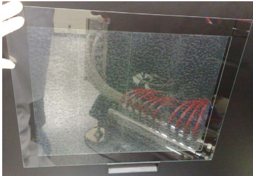
Abbildung 4-9: „Glas auf Glas“-Lamination mit einer doppelseitigen Klebefolie
