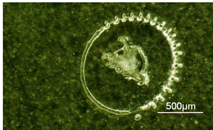
Abbildung 4-6: Partikeleinschluss in einer Transferklebefolie
