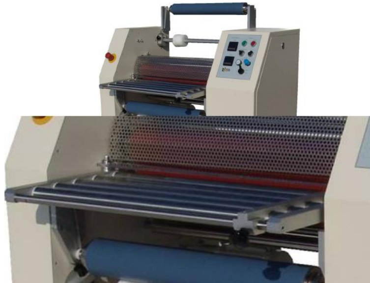
Abbildung 3-9: Rolleneinlaufsystem (Modell UVL der Firma „Fetzel Maschinenbau GmbH“)
