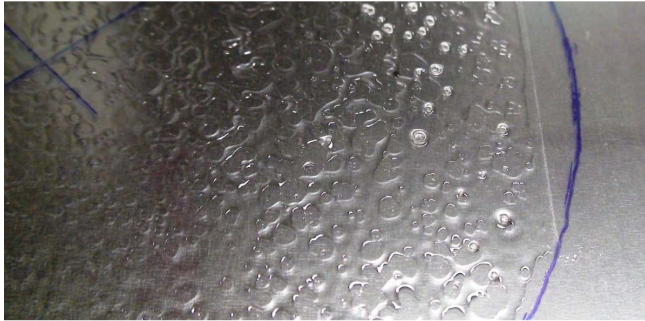
Abbildung 4-23: Benetzung des Flüssigklebstoffes auf der 3M TYP B-Barrierefolie
