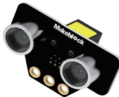
Abbildung 5: Ultraschallsensor(Quelle[mBot ranger Bedienungsanleitung])
