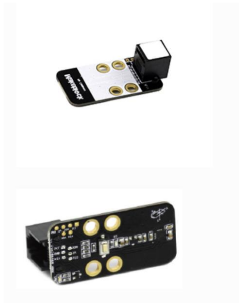
Abbildung 13: Kompass Sensor(Quelle[mBot ranger Bedienungsanleitung])
