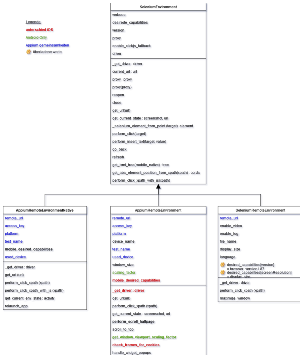
Abbildung 4.2: Klassendiagramm des alten Environments
