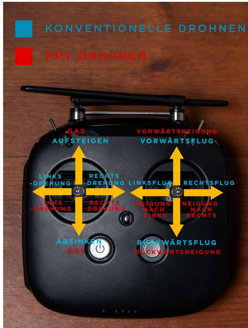
Abbildung 1: Steuerung von Konventionellen und FPV-Drohnen<sup>21</sup>
