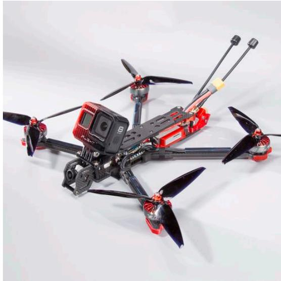
Abbildung 4: 7 Zoll Long Range FPV-Drohne<sup>61</sup>
