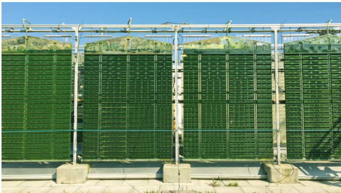
Abbildung 4.2: Beispielbild eines Panel Airlift-Reaktors zur Mikroalgenkultivierung(Boldt, 2020)
