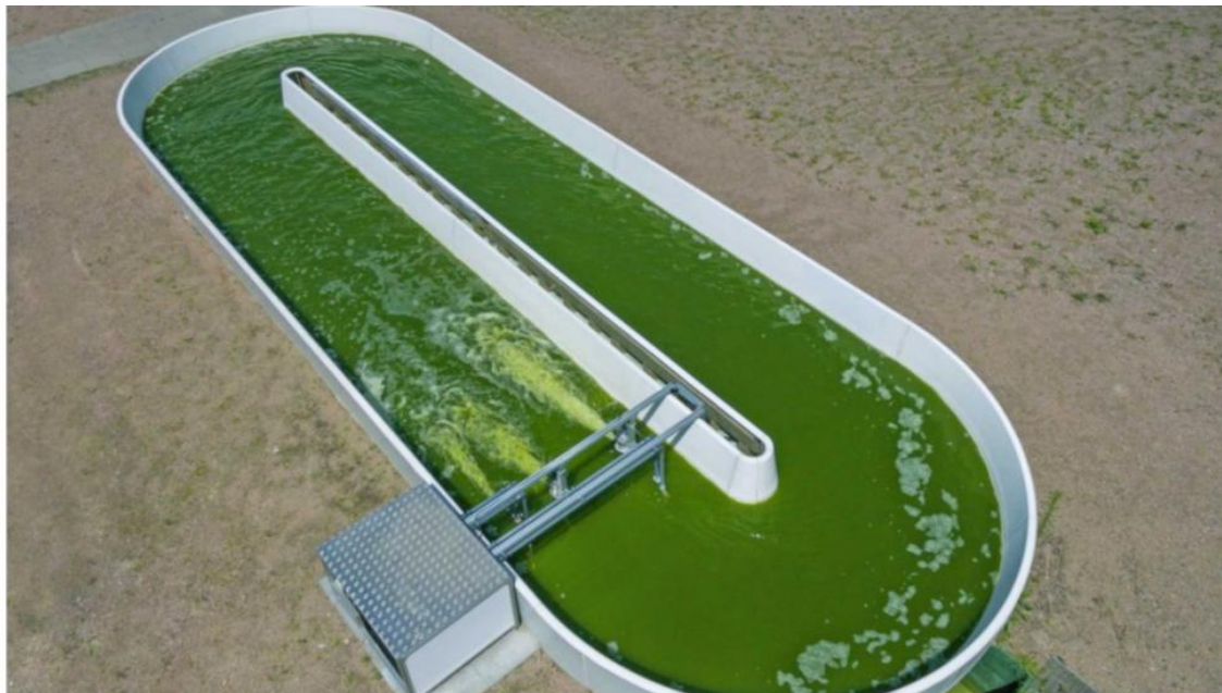
Abbildung 4.1: Beispielbild eines offenen Teichsystems zur Mikroalgenkultivierung (Boldt, 2020)
