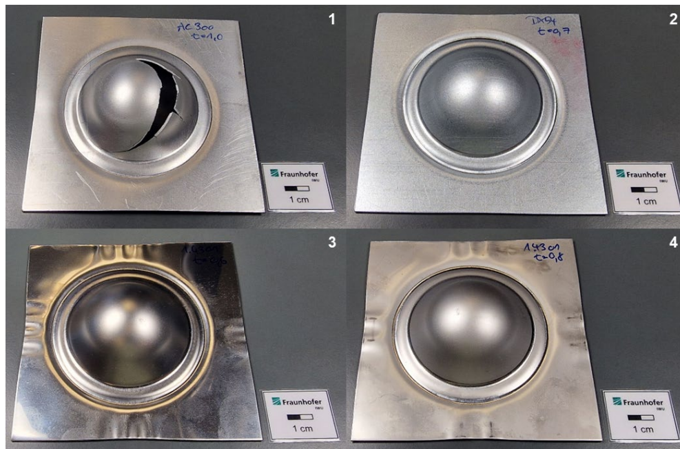
Abbildung 16: Ergebnisse aus Tiefziehversuchen mit AC300 (1), DX54 (2), 1.4301 0,6 mm (3) und 1.4301 0,8mm (4), durchgeführt ohne Schmierung und langsamer Ziehgeschwindigkeit (eigene Darstellung).
