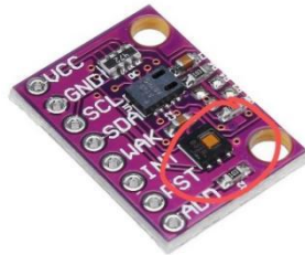
Abbildung 7: HDC1080 auf dem Modul [A2]
