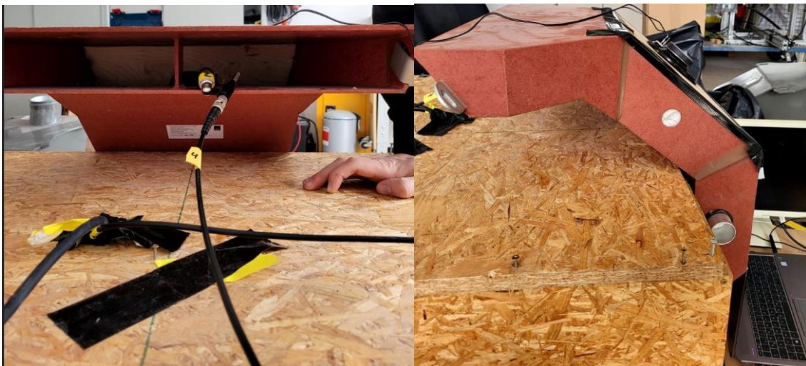
Abbildung 31 - Messung mit Zuluftkanal aus der Vectron-Lokomotive
