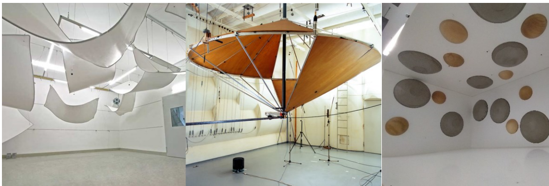
Abbildung 1: Hallräume mit Diffusorpaneelen (links) (Müller-BBM Acoustic Solutions GmbH), rotierendem Diffusor (mitte) (Vorländer, 2015) und Volumenkörperdiffusoren (rechts)
