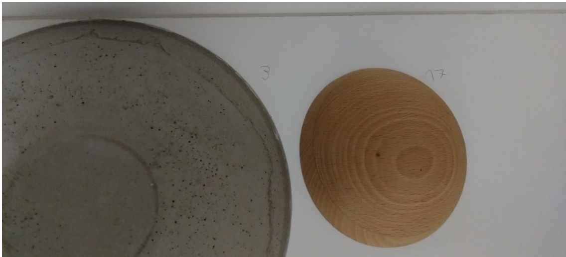
Abbildung 8: Kugelsegmentdiffusoren in großer Ausführung aus Beton (links) und kleiner Ausführung aus lackiertem Buchenholz (rechts) mit formschlüssiger Befestigung
