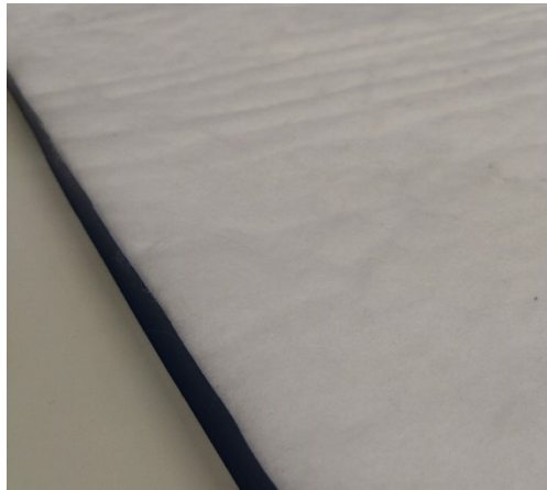
Bild 4: Kantenbegrenzung der Absorberelemente, exemplarisch am großen Polyesterfaserabsorber
