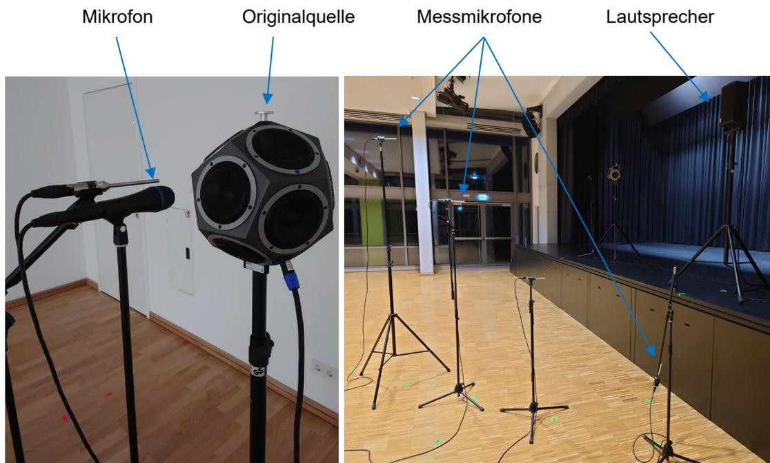
Abbildung 67: Messaufbau zur Erfassung des AGbF (links BR C; rechts VR A)
