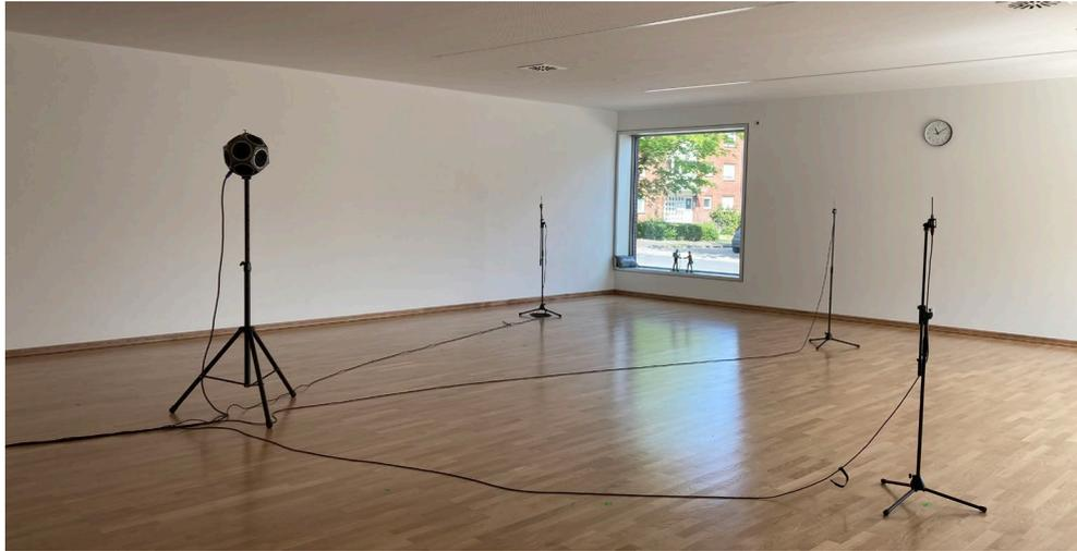
Abbildung 66: Messaufbau zur Erfassung der Nachhallzeit (SR C)
