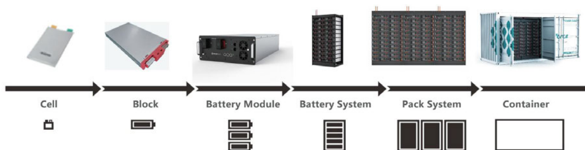
Abbildung 3.3: Systemkette von der Batteriezelle bis zum Batteriecontainer [13]
