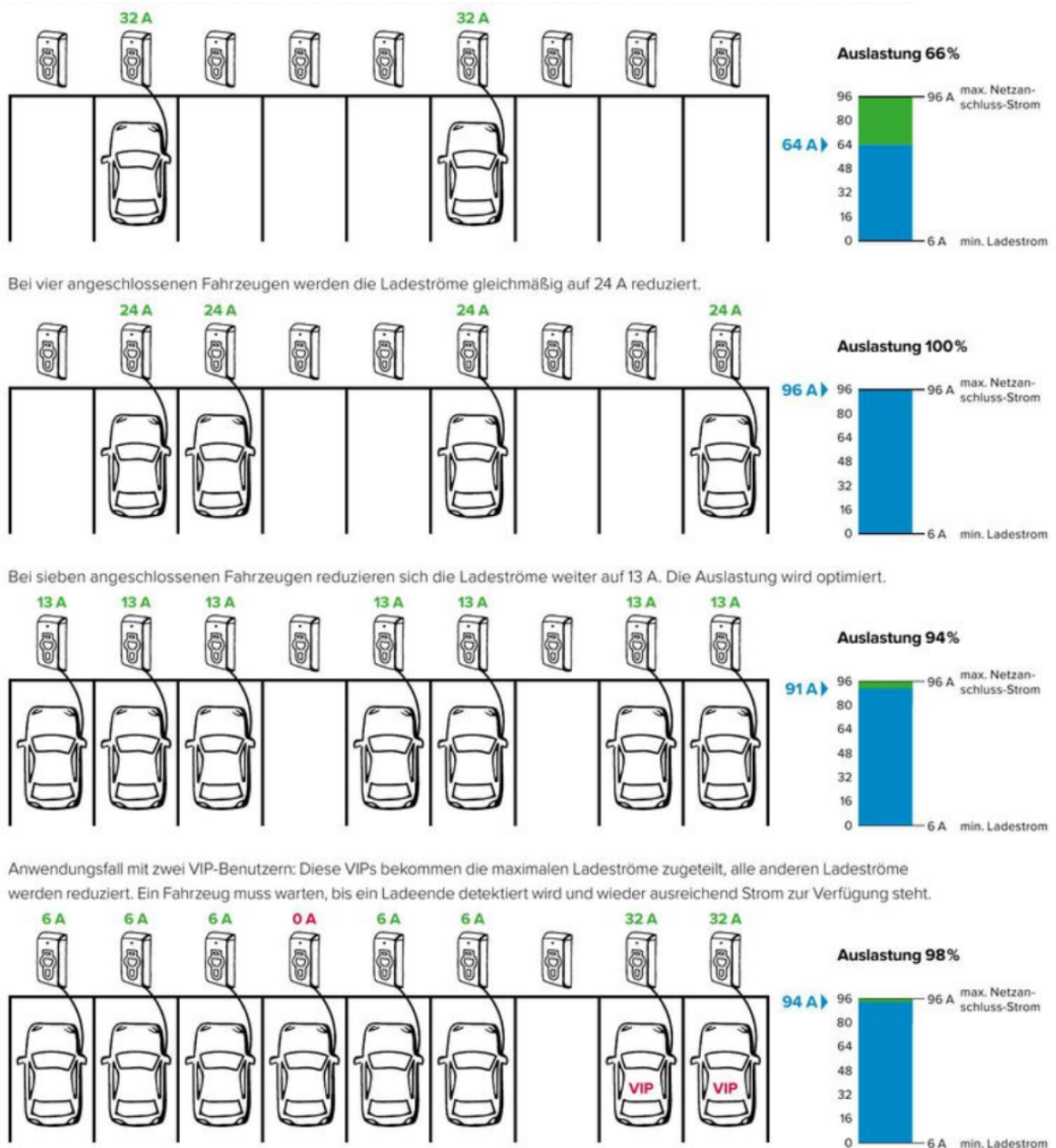
Abbildung 36: Beispiel zur Vermeidung von Lastspitzen Charge up in Control – Menekes Lastmanagement
