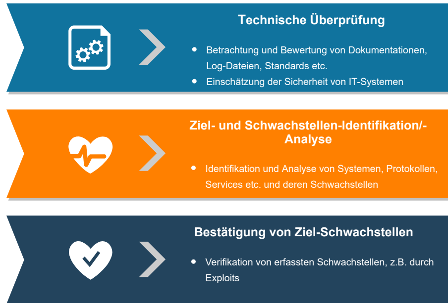
Abbildung 2.2: Veranschaulichung der drei Verfahrenskategorien für Sicherheitstests [eigene Abbildung nach [48, S. 2-2 bis 2-3]]
