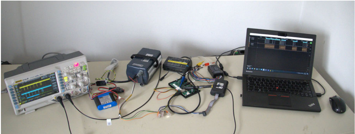
Abbildung 4.13: ACC: Benötigte Hardware für das Debugging der Buskommunikation
