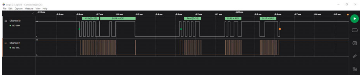
Abbildung 2.5: Abfrage des Kapazitätsregisters eines bq34z100G1-Prozessors auf dem I 2 C-Bus
