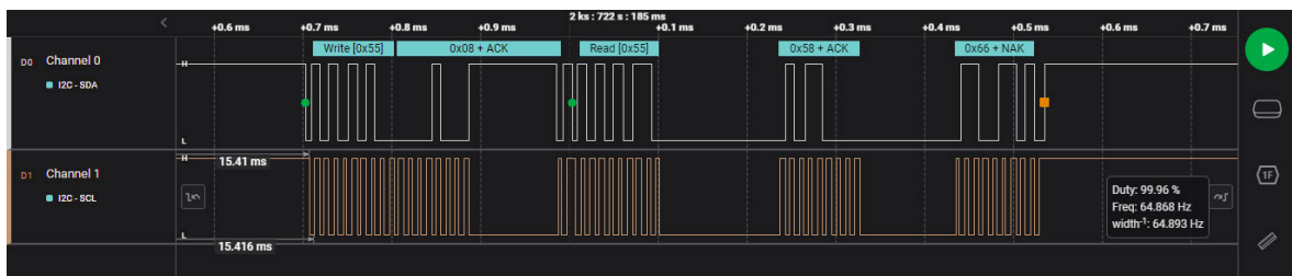
Abbildung 4.14: Aardvark: Auslesen des I 2 C-Buses mit der „Logic 2“-Software
