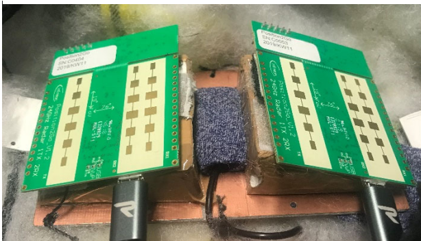
Abbildung 38: Radar-Sensoren auf Sockel
