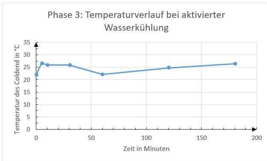
Abbildung 20 Phase 3: Temperaturverlauf bei aktivierter Wasserkühlung 29
