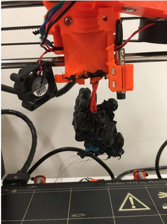
Abbildung 6 Mechanische Zerstörung eines Extruder durch Überhitzung 11
