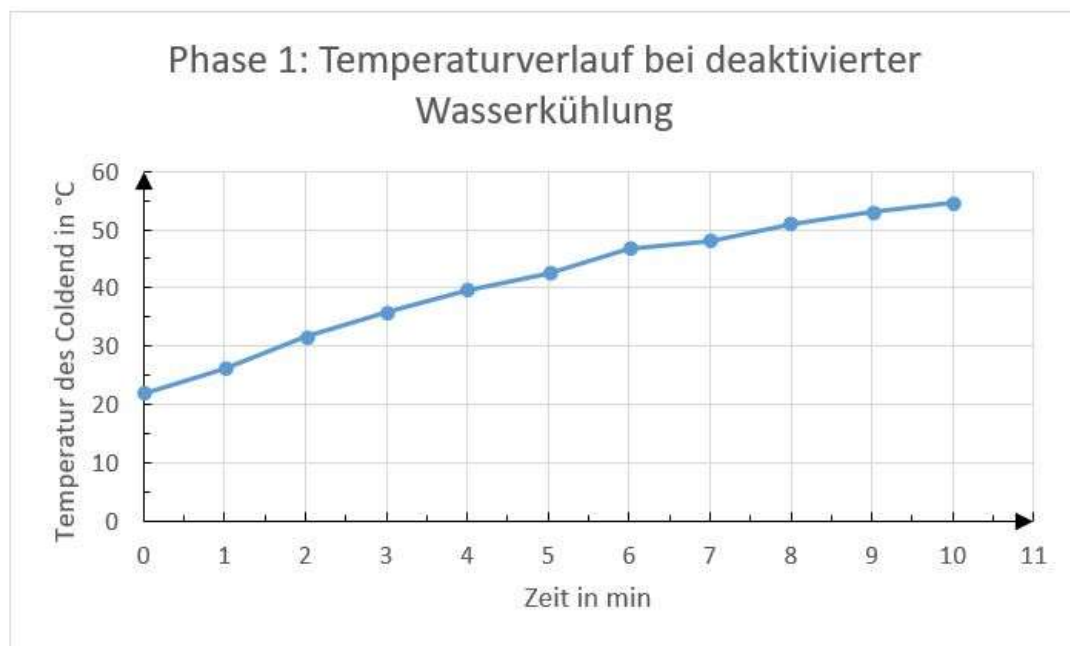
Abbildung 18 Phase 1: Temperaturverlauf bei deaktivierter Wasserkühlung 27
