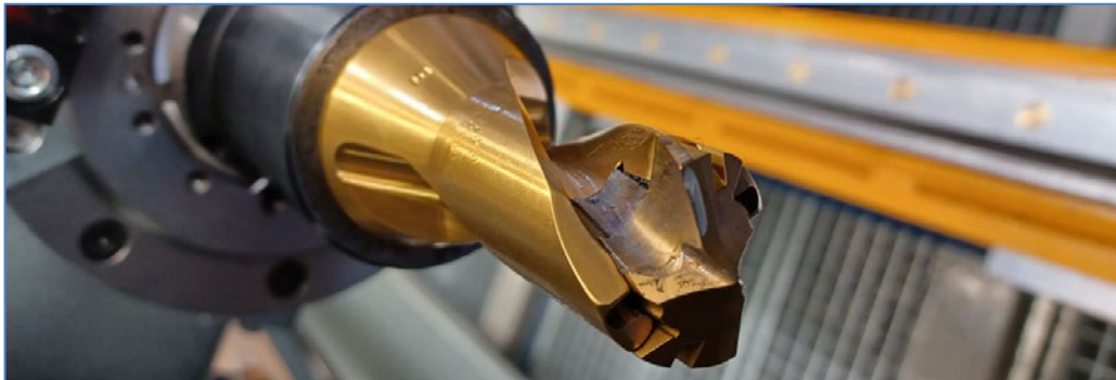
Abb. 98: Ø18mm Vollbohrer mit VHM – Wechselkopf
