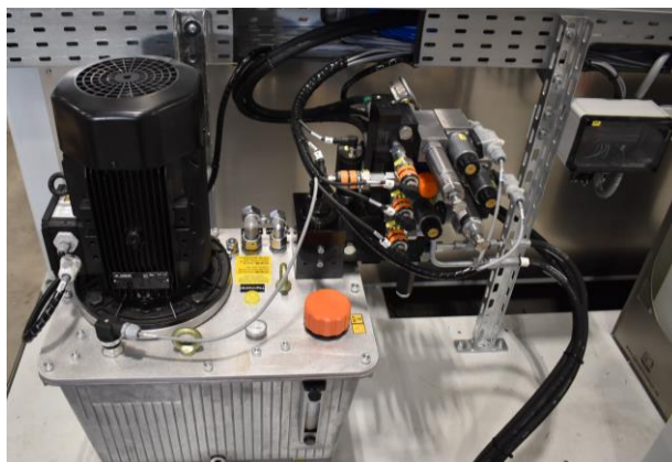
Abb. 54: Modul – Hydraulikaggregat mit Ventilblock
