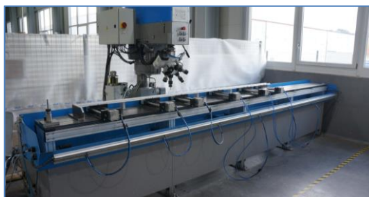
Abb. 10: Plantec Bohrautomat für Stangenmaterial 8
