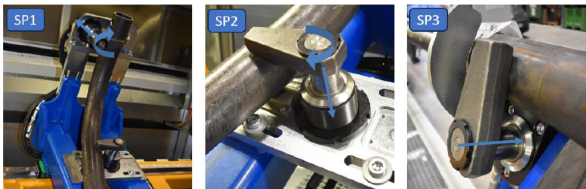
Abb. 49: Schwenkspanner für Spannpunkt 1 und 2; Linearspanner für Spannpunkt 3
