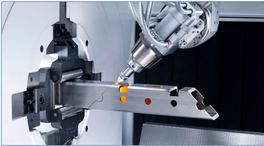
Abb. 13: 3D - Rohrlaseranwendung für rechteckiges Formrohr im Stangenformat 11
