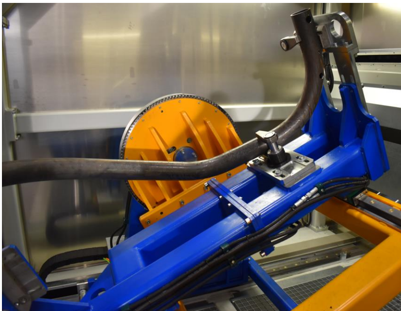
Abb. 48: montierte Bauteilaufnahme mit eingespanntem Hauptrohr
