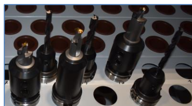
Abb. 94: Bearbeitungswerkzeuge in unterschiedlichen HSK-A 63 Aufnahmen
