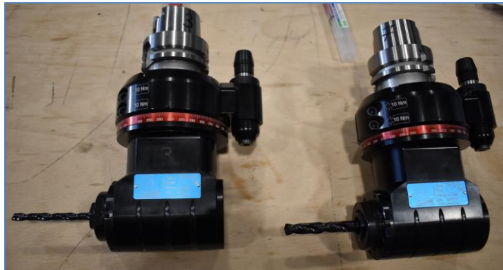
Abb. 95: TA13.CP Winkelkopf mit VHM – Bohrer
