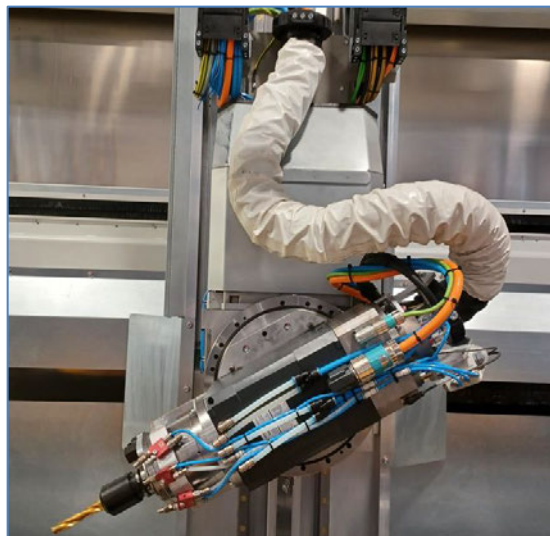
Abb. 104: Hybridspindel mit WZ - Schmierung
