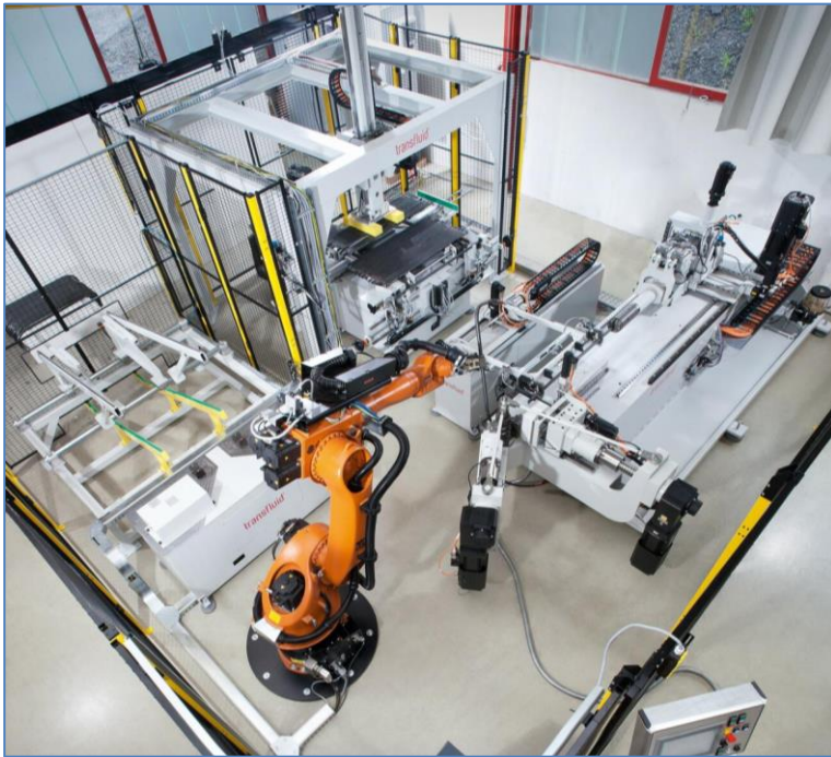
Abb. 11: Automatisierungslösung für den Biegeprozess mit Be-, und Entladung 9
