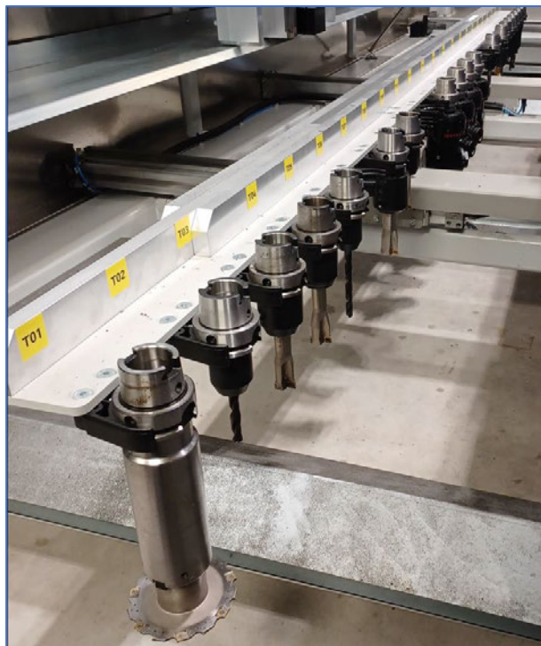
Abb. 102: pneumatischer Werkzeugbahnhof mit 26 Werkzeugwechsellätzen
