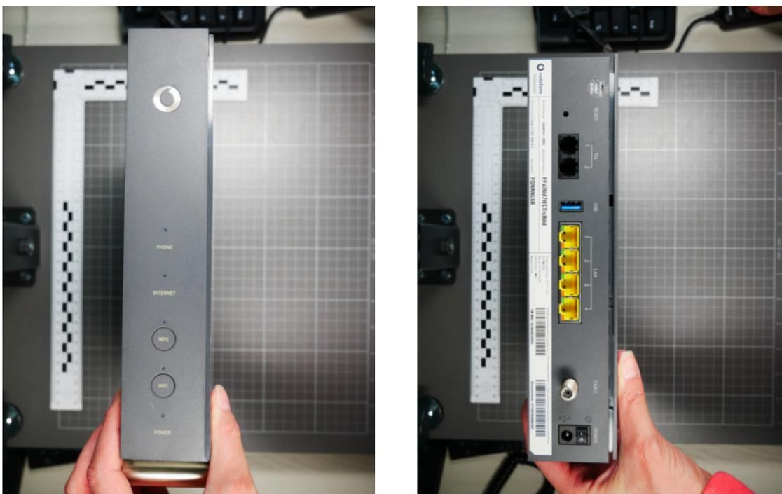
**Abbildung 4.1:** Vodafone Station Arris TG3442DE- Vorderseite und Rückseite
