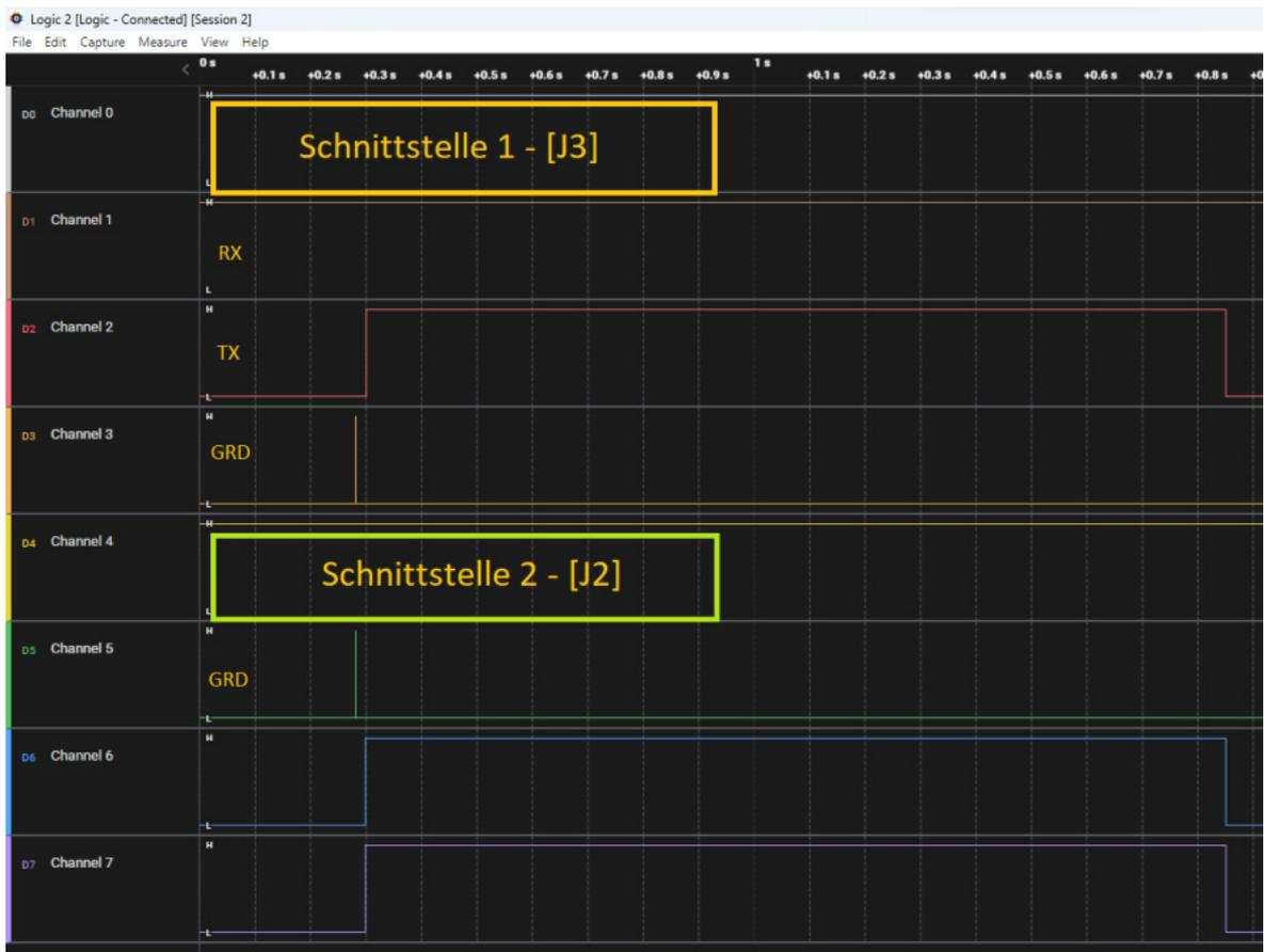
Abbildung J.1: Vodafone Station Arris TG3442DE - Softwareausgabe Logik Analysator 'saneae'
