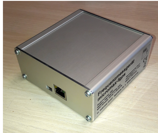
(b) Rückseite des Messgeräts: Anschlüsse v.l.n.r. Mini-USB, Ethernet.
