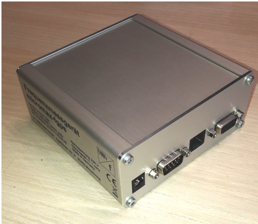
(a) Vorderseite des Messgeräts: Anschlüsse v.l.n.r. AC Eingang, RS-232, RJ-12, RS-485
