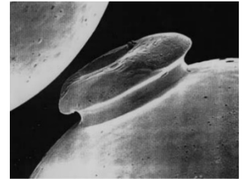
Abbildung 6: links: Soll-Geometrie grau und Ist-Geometrie violett; rechts: Beispielhafte REM-Aufnahme eines abgebrochenen Sinterhalses zwischen zwei Wolframteilchen (Salmang et al. 2007)
