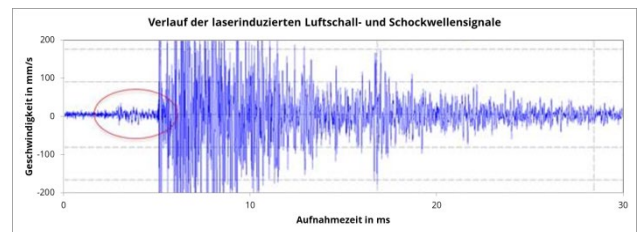
Abbildung 5: Messaufzeichnung der laserinduzierten akustischen Signale auf dem Asphaltprobekörper. Die im roten Bereich markierten Signalausschläge werden aufgrund der höheren Ausbreitungsgeschwindigkeit dem, für die Asphaltvermessung notwendigen Schockwellensignal zugeordnet.
