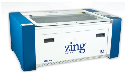
Abbildung 4: CO 2 -Lasers EPILOG ZING Modell 10000 zur Fixierung der Pulverstruktur
