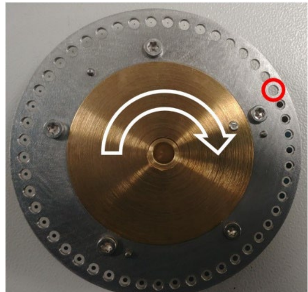
Abbildung 2: Maskenrad (roter Kreis: kleinste Maske, weißer Pfeil: Drehrichtung).
