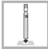
15. Probenküvette in den Küvetten-schacht einsetzen. DR1900 MESSEN drücken.
