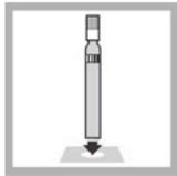
13. Verdünnungswasser küvette in den Küvetten-schacht einsetzen. DR1900 LCK/TNTplus Verfahren anwählen. Test anwählen, NULL drücken.
