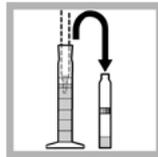
8. Messkolben öffnen. 0,5 mL Standardlösung (50 mL Messkolben) direkt in die Probenküvette pipettieren.
