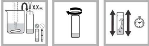
5. Pipetieren Sie Probe und Verdünnungswasser, hergestellt wie in 2. Probenvorbereitung auf Seite 2 beschrieben, in das Reaktionsglas.
