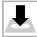
14. Küvette in Küvetten-schacht einsetzen. DR1900 LCK/TNTplus Verfahren anwählen. Test anwählen, MESSEN drücken.
