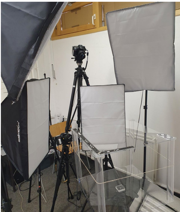
Abbildung 4: Scan-Setup für die Aufnahme der Bilder zur 3D-Digitalisierung des Kissens mithilfe von Structure-from-Motion.
