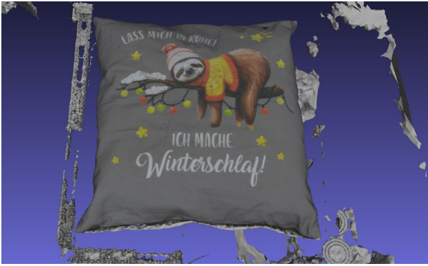
Abbildung 6: Durch Structure-from-Motion berechnetes realskaliertes 3D-Modell des Kissens.
