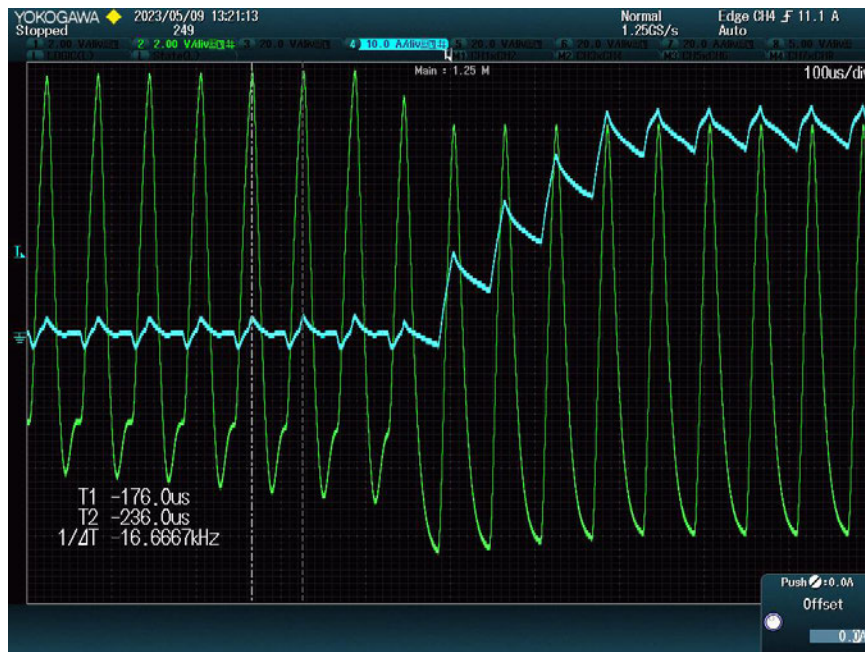
Abbildung 4: In Praktikum gemessen Schaltfrequenz von PWM
