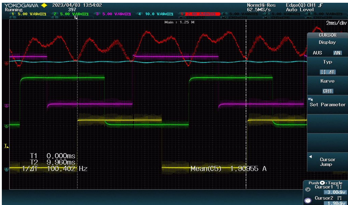
Abbildung 16: Messung von Strom und Spannung am Eingang in Praktikum
