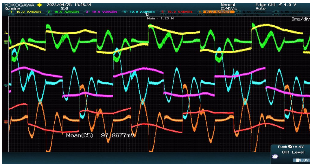
Abbildung 19:Beziehung zwischen dreiphasig Strömen und Hallsignalen in Portunus
