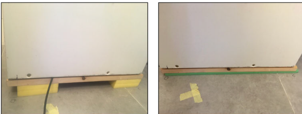
Abbildung 15: elastische Ankopplung - gelb SR11 (links) und grün SR55 (rechts)
