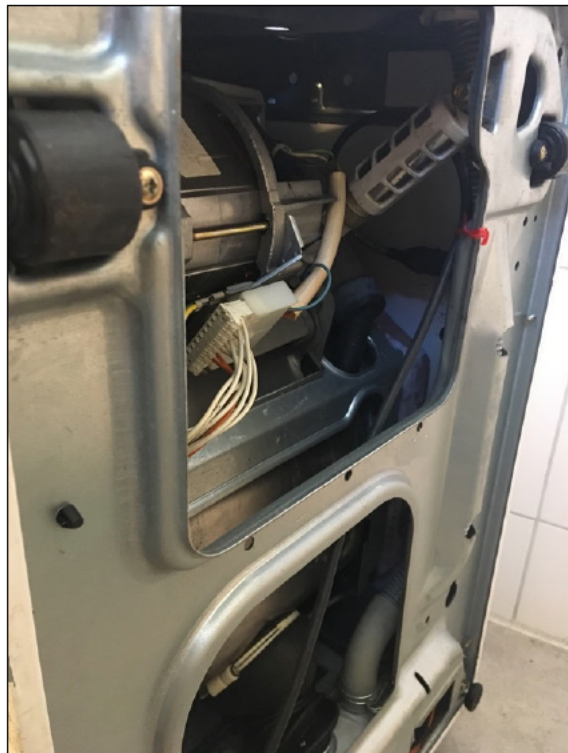
Abbildung 37 & 38: Trommelaufhängung & Schnelleaufnehmer im Gehäuse
