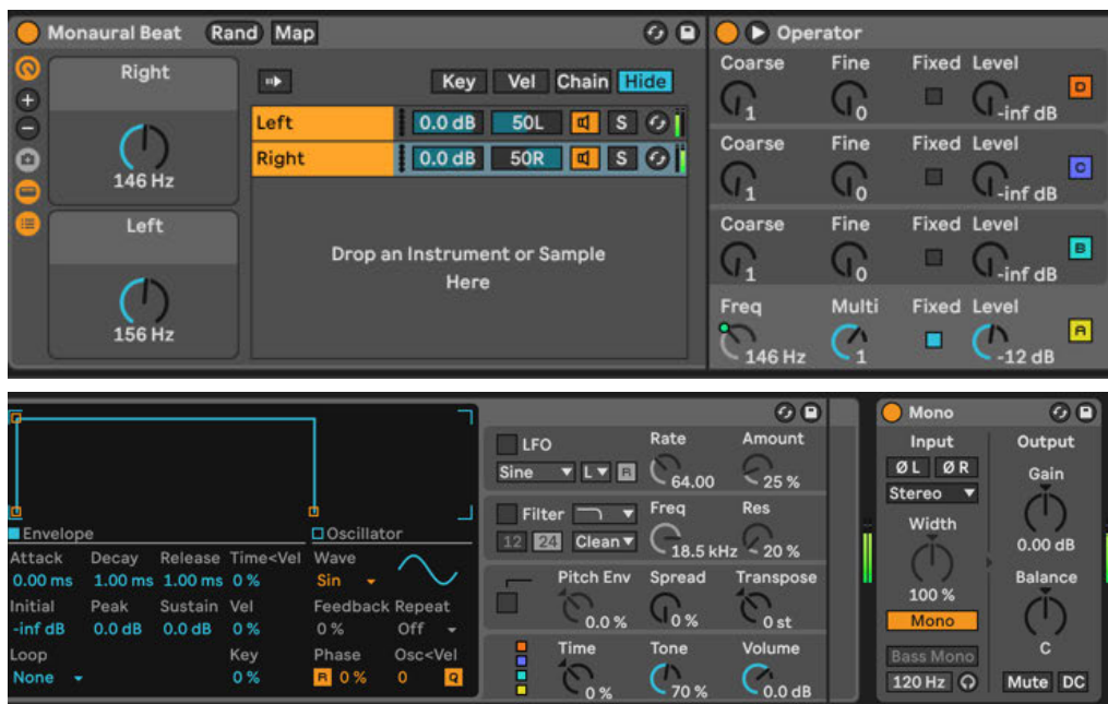
Abbildung 6: Erzeugung eines monauralen Beats in Ableton Live 11 mit Operator und Mono Plugin (eigene Abbildung)
