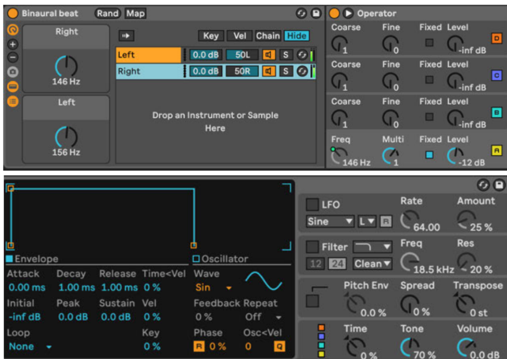
Abbildung 5: Erzeugung eines binauralen Beats in Ableton Live 11 mit Operator (eigene Abbildung)
