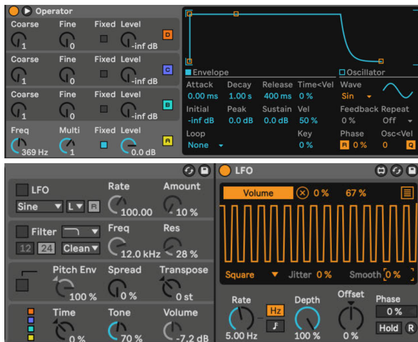
Abbildung 9: Erzeugung eines isochronen Tons in Ableton Live 11 mit Operator und einem LFO (eigene Abbildung)
