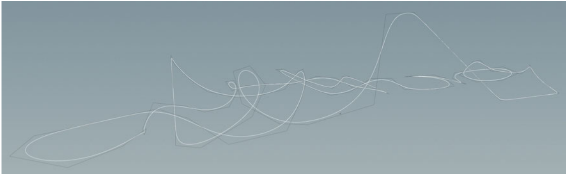
Abbildung 4.3.: In weiß ist die geglättete Kurve des Achterbahnlayouts zu sehen. Die Polygonkurve ist in grau daneben zu erkennen.
