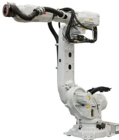
Abbildung 15: ABB Robotersystem IRB6700 [2]
