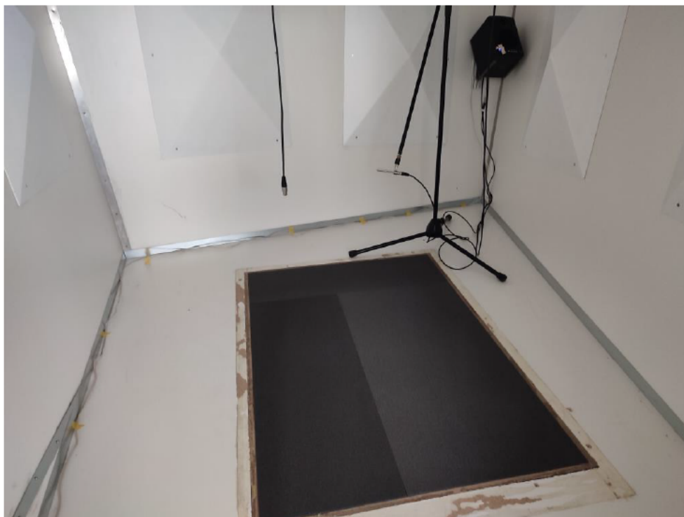
Abbildung 16 – Ansicht der Hallkabine mit Prüfobjekt
