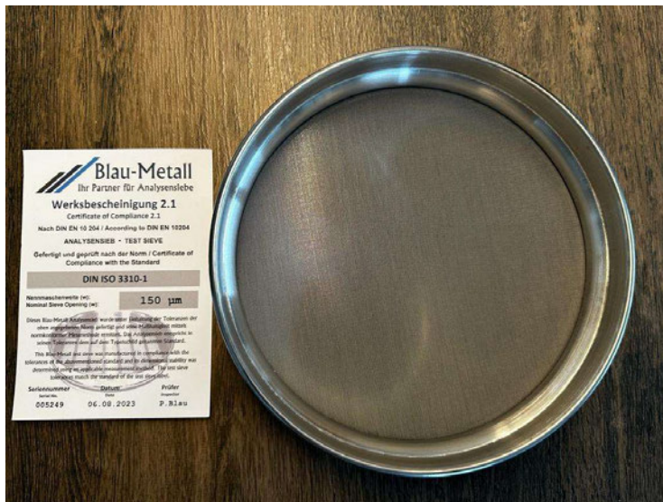
Abbildung 35: 150 µm Prüfsieb zum gleichmäßigen Aufklopfen von Prüfstaub
