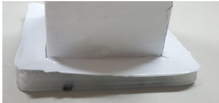
Abbildung 78: 3_Allgemeines Muster_FFF_Quader in PP (0,4mm) mit Wrap Folie Serie 2080 (110µm) und Hexis CARPRO300 (300µm)_#2
