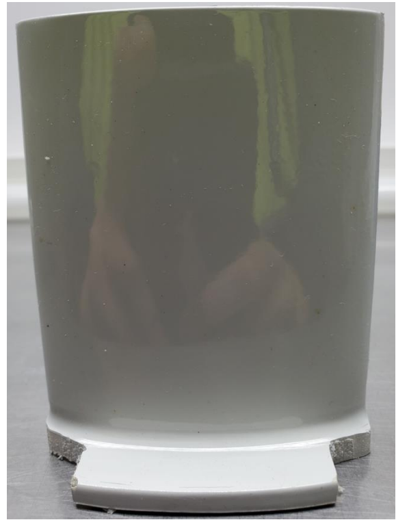
Abbildung 185: 5_Allgemeines Muster_FFF_Ellipse in PP (0,6 mm) mit LECHSYS LS155, weiß_nach Bewitterung_#1
