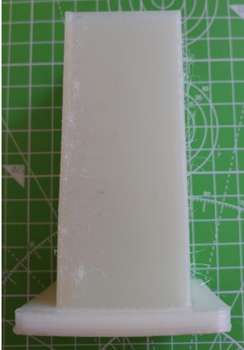
Abbildung 33: 3_Allgemeines Muster_FFF_Quader in PA6 (0,4mm)_#1
