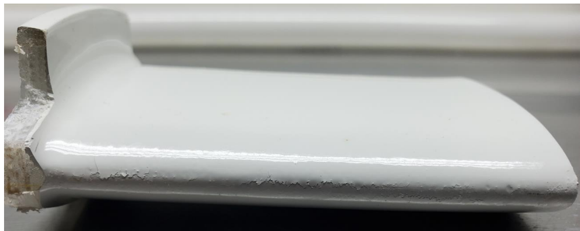
Abbildung 186: 5_Allgemeines Muster_FFF_Ellipse in PP (0,6 mm) mit LECHSYS LS155, weiß_nach Bewitterung_#2
