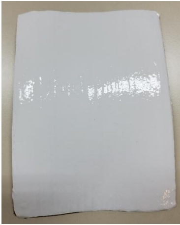
Abbildung 145: 1_Allgemeines Muster_UD-Tape_1 in PP Flax 50 mit Wrap Folie Serie 2080 (110µm)
