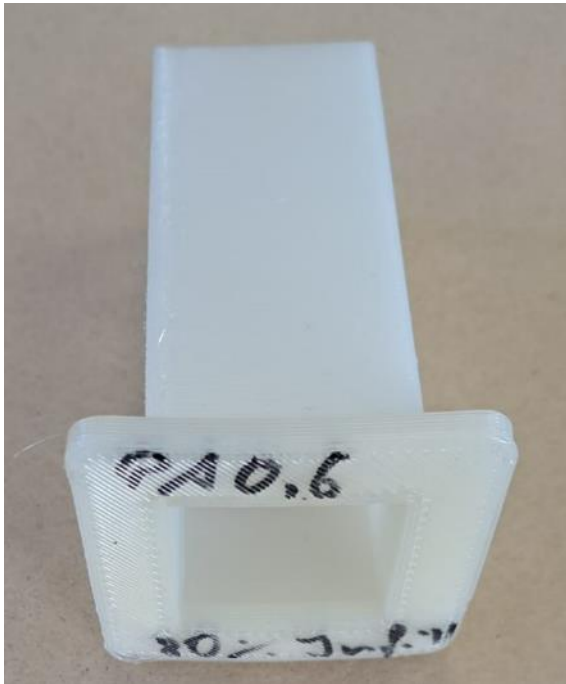
Abbildung 105: 3_Allgemeines Muster_FFF_Quader in PA6 (0,6mm)_#1
