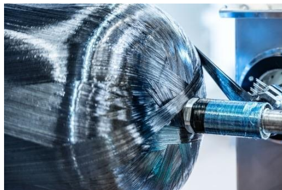
Abbildung 1: Herstellung mittels UD-Tape-Legen 1
