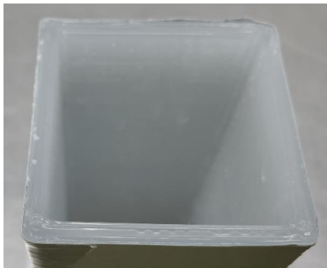
Abbildung 251: 3_Allgemeines Muster_FFF_Quader in PP (0,4mm) mit 3M Wrap Folie Serie 2080 (110µm)_nach Test_#3
