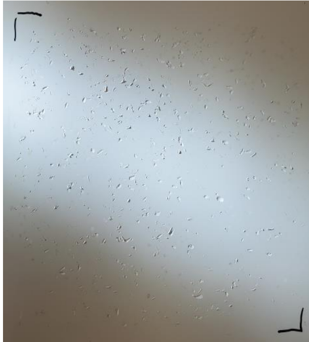
Abbildung 130: 1_Allgemeines Muster_UD-Tape_1 in PA6 Carbon mit LECHSYS LS155, weiß_#2
