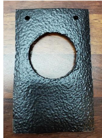
Abbildung 148: 2_Allgemeines Muster_UD-Tape_2 in MCP1223 PA6 CF mit Raptor, schwarz_zugeschnitten
