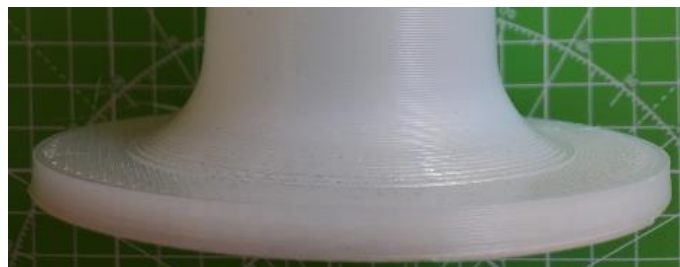
Abbildung 83: 4_Allgemeines Muster_FFF_Zylinder in PA6 (0,4mm)_#2
