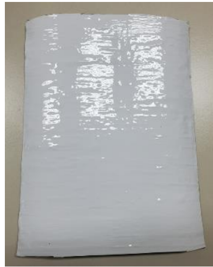
Abbildung 52: 1_Allgemeines Muster_UD-Tape_1 in MCP1223 PA6 CF mit Hexis CARPRO300 (300µm) #1
