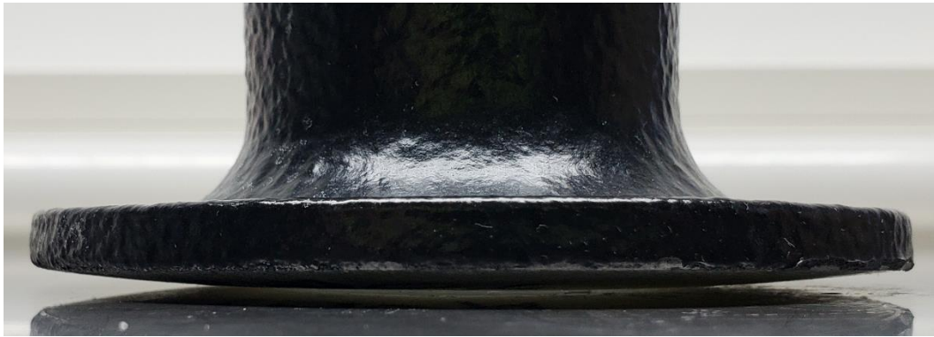
Abbildung 260: 4_Allgemeines Muster_FFF_Zylinder in PA6 (0,4mm) mit Upol RAPTOR, schwarz_nach Test_#3
