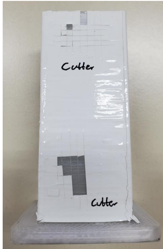
Abbildung 222: 3_Allgemeines Muster_FFF_Quader in PP (0,4) mit Hexis (300µm)_#2
