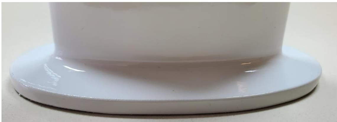
Abbildung 120: 5_Allgemeines Muster_FFF_Ellipse in PA6 (0,6 mm) mit LECHSYS LS155, weiß_#3
