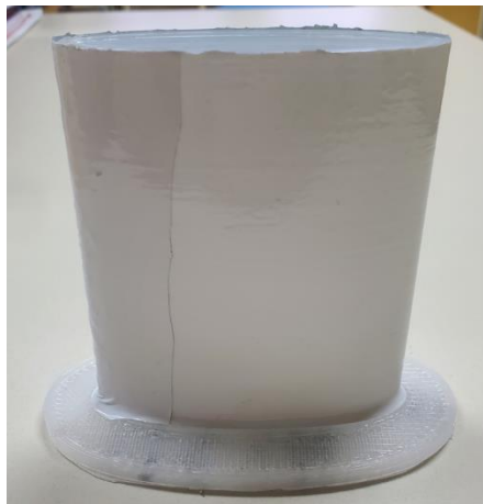
Abbildung 153: 5_Allgemeines Muster_FFF_Ellipse in PP (0,4mm) mit Hexis CARPRO300 (300µm)
