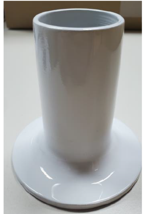
Abbildung 114: 4_Allgemeines Muster_FFF_Zylinder in PP (0,4 mm) mit LECHSYS LS155, weiß_#1
