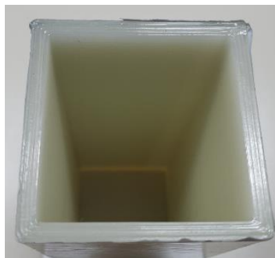
Abbildung 72: 3_Allgemeines Muster_FFF_Quader in PA6 (0,4mm) mit Hexis CARPRO300 (300µm) _#2
