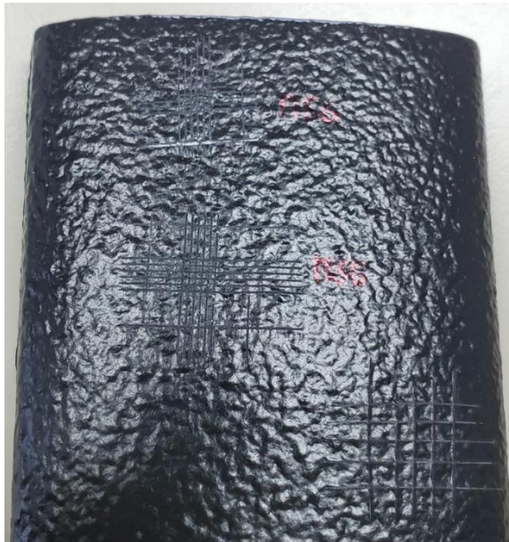
Abbildung 227: 5_Allgemeines Muster_FFF_Ellipse in PP (0,4mm) mit Upol Raptor, schwarz_#1
