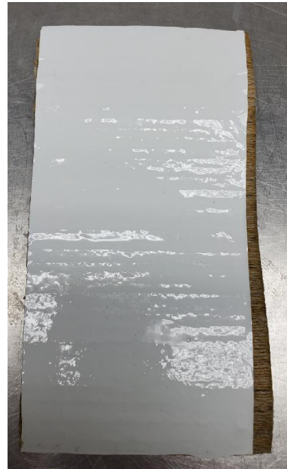
Abbildung 158: 1_Allgemeines Muster_UD-Tape_1 in PP Flax 50 mit Wrap Folie Serie 2080 (110µm)_nach Bewitterung_#1
