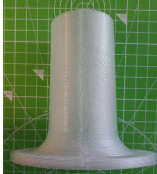
Abbildung 40: 4_Allgemeines Muster_FFF_Zylinder in PP (0,6mm)_#1
