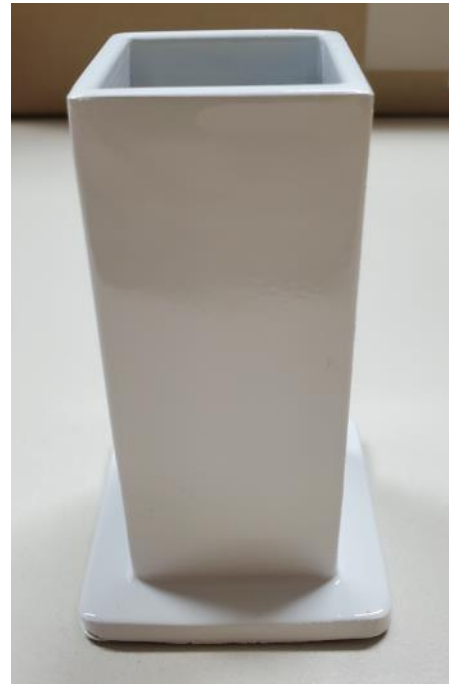
Abbildung 106: 3_Allgemeines Muster_FFF_Quader in PA6 (0,6mm) mit LECHSYS LS155, weiß_#1
