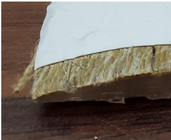
Abbildung 159: 1_Allgemeines Muster_UD-Tape_1 in PP Flax 50 mit Wrap Folie Serie 2080 (110µm)_vor Bewitterung_#2
