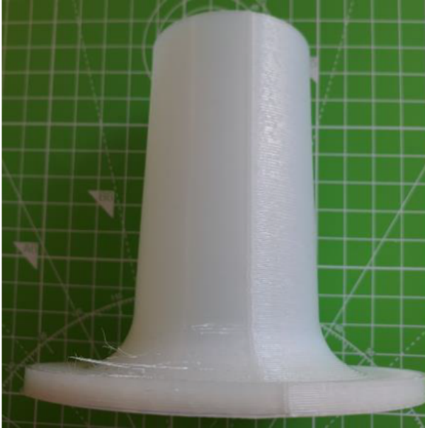
Abbildung 39: 4_Allgemeines Muster_FFF_Zylinder in PA6 (0,4mm)_#1
