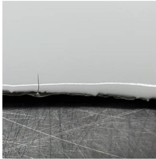
Abbildung 248: 2_Allgemeines Muster_UD-Tape_2 in PA6 Carbon LECHSYS LS155, weiß_nach Test_#5
