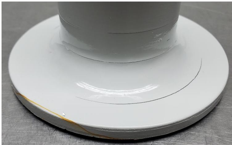
Abbildung 264: 4_Allgemeines Muster_FFF_Zylinder in PA6 (0,6mm) mit LECHSYS LS155, weiß_nach Test_#3
