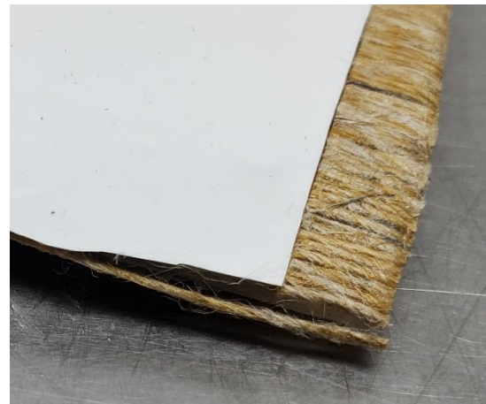
Abbildung 160: 1_Allgemeines Muster_UD-Tape_1 in PP Flax 50 mit Wrap Folie Serie 2080 (110µm)_nach Bewitterung_#2
