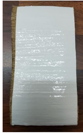
Abbildung 146: 1_Allgemeines Muster_UD-Tape_1 in PP Flax 50 mit Wrap Folie Serie 2080 (110µm)_zuge-schnitten
