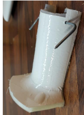
Abbildung 152: 4_Allgemeines Muster_FFF_Zylinder in PA6 (0,4mm) mit Hexis CARPRO300 (300µm)_zuge-schnitten
