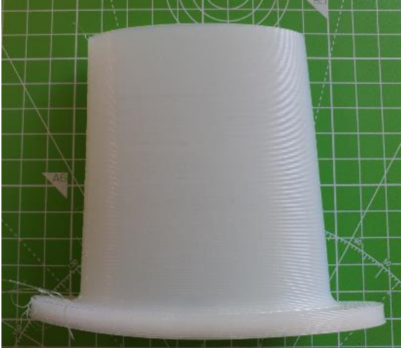
Abbildung 45: 5_Allgemeines Muster_FFF_Ellipse in PA6 (0,6mm)_#1
