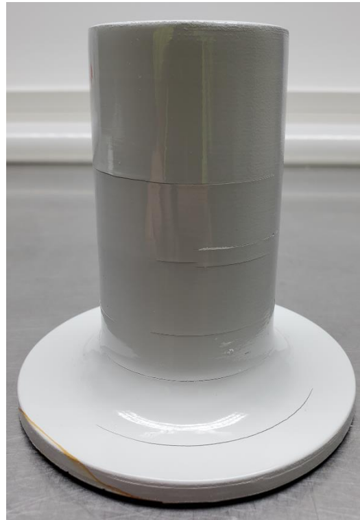
Abbildung 263: 4_Allgemeines Muster_FFF_Zylinder in PA6 (0,6mm) mit LECHSYS LS155, weiß_nach Test_#2
