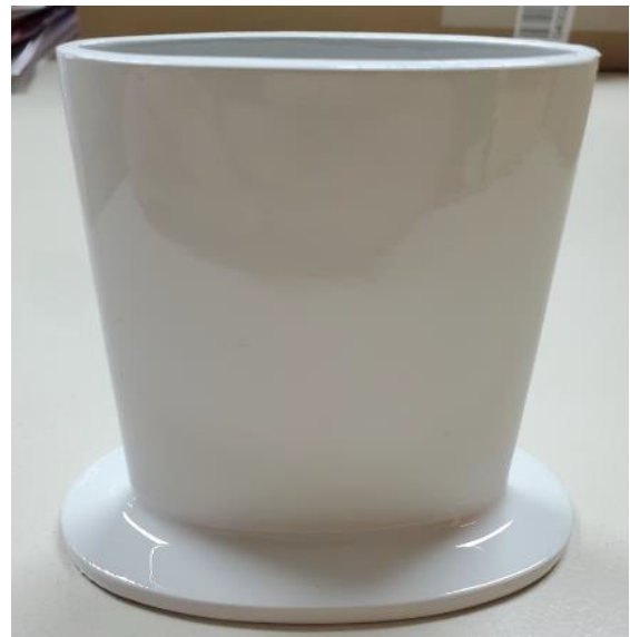
Abbildung 118: 5_Allgemeines Muster_FFF_Ellipse in PA6 (0,6 mm) mit LECHSYS LS155, weiß_#1
