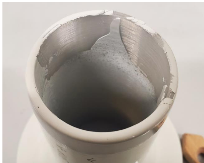
Abbildung 209: 4_Allgemeines Muster_FFF_Zylinder in PP (0,4mm) mit LECHSYS LS155, weiß_#2
