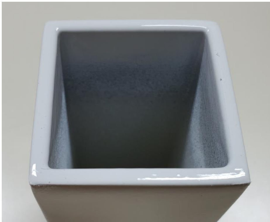
Abbildung 107: 3_Allgemeines Muster_FFF_Quader in PA6 (0,6mm) mit LECHSYS LS155, weiß_#2
