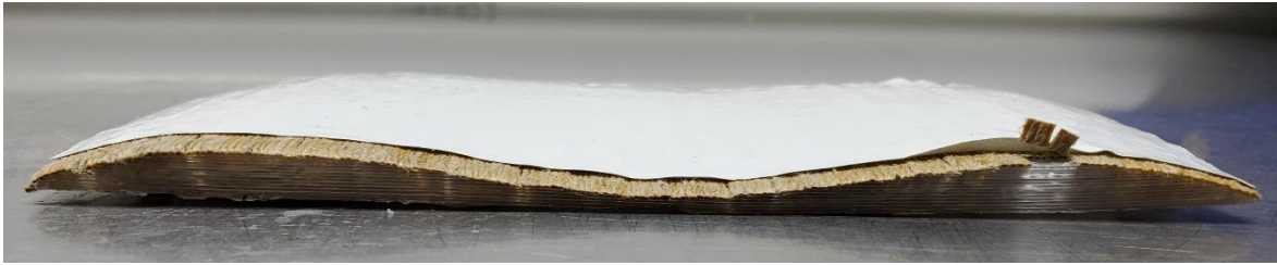
Abbildung 161: 1_Allgemeines Muster_UD-Tape_1 in PP Flax 50 mit Wrap Folie Serie 2080 (110µm)_nach Bewitterung_#3
