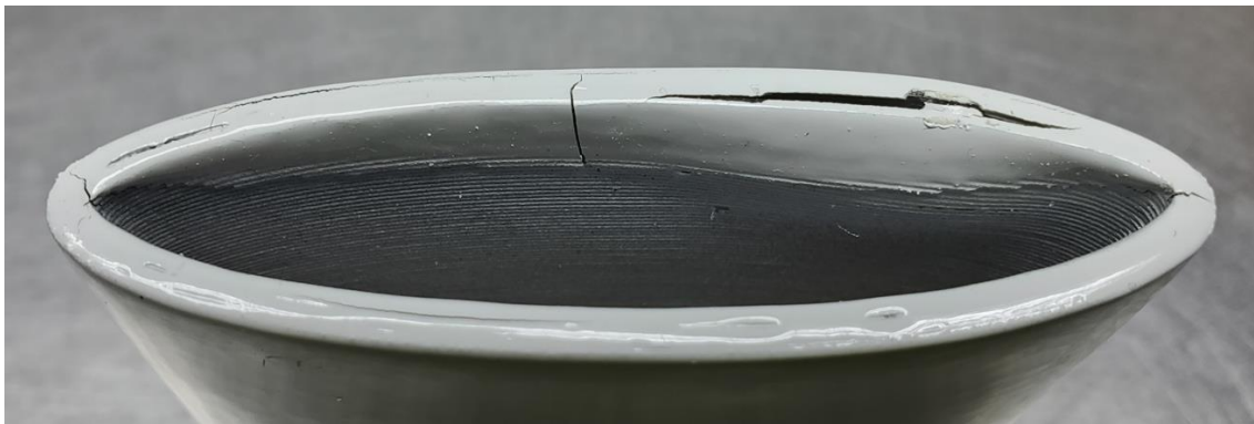
Abbildung 189: 5_Allgemeines Muster_FFF_Ellipse in PP (0,6 mm) mit LECHSYS LS155, weiß_nach Bewitterung_#4
