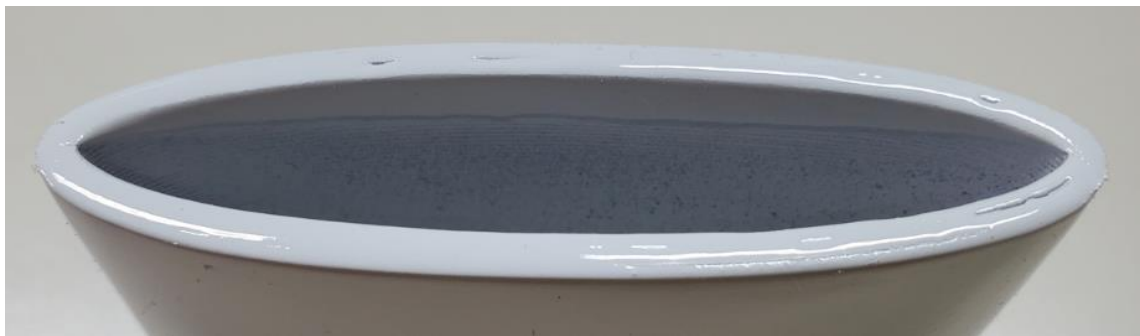
Abbildung 119: 5_Allgemeines Muster_FFF_Ellipse in PA6 (0,6 mm) mit LECHSYS LS155, weiß_#2
