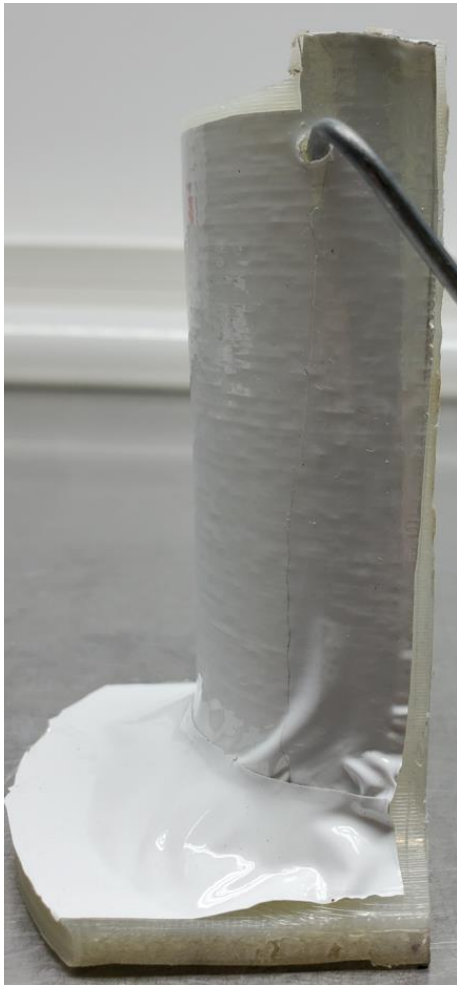
Abbildung 177: 4_Allgemeines Muster_FFF_Zylinder in PA6 (0,4mm) mit Hexis CARPRO300 (300µm)_nach Bewitterung_#3
