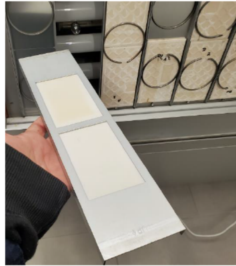
Abbildung 141: Probehalterung mit zwei eingespannten Standardproben
