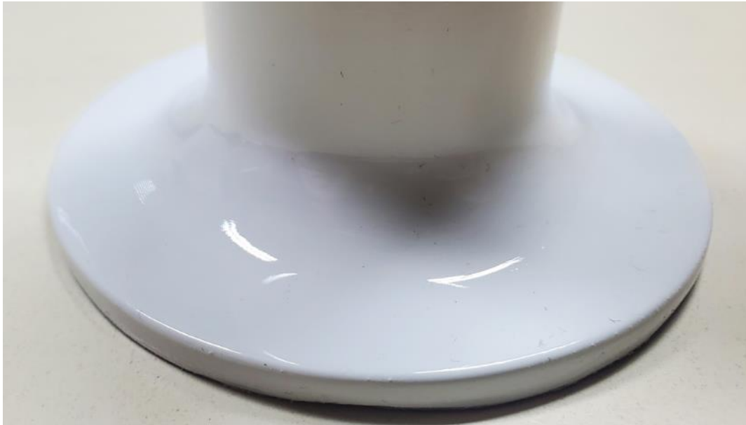
Abbildung 116: 4_Allgemeines Muster_FFF_Zylinder in PP (0,4 mm) mit LECHSYS LS155, weiß_#3
