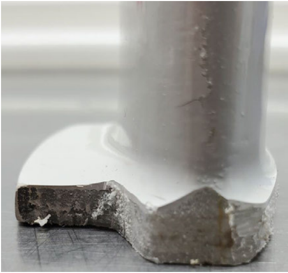
Abbildung 187: 5_Allgemeines Muster_FFF_Ellipse in PP (0,6 mm) mit LECHSYS LS155, weiß_nach Bewitterung_#3
