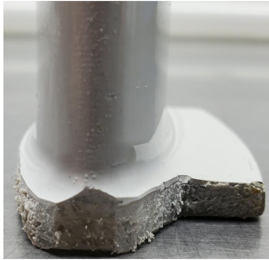
Abbildung 188: 5_Allgemeines Muster_FFF_Ellipse in PP (0,6 mm) mit LECHSYS LS155, weiß_nach Bewitterung_#4
