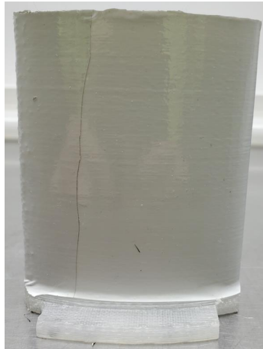
Abbildung 180: 5_Allgemeines Muster_FFF_Ellipse in PP (0,4mm) mit Hexis CARPRO300 (300µm)_nach Bewitterung_#1
