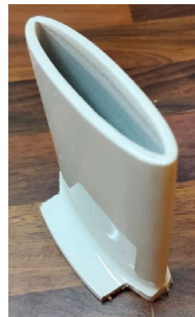
Abbildung 156: 5_Allgemeines Muster_FFF_Ellipse in PP (0,6 mm) mit LECHSYS LS155, weiß_zugeschnitten
