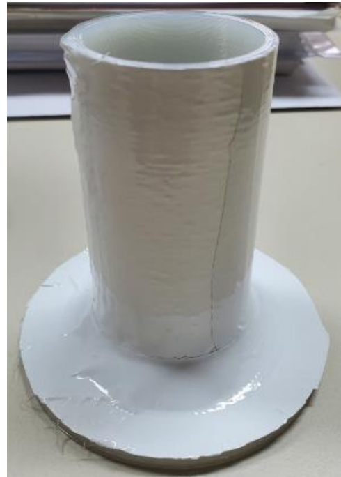
Abbildung 82: 4_Allgemeines Muster_FFF_Zylinder in PA6 (0,4mm) mit Hexis CARPRO300 (300µm)_#1
