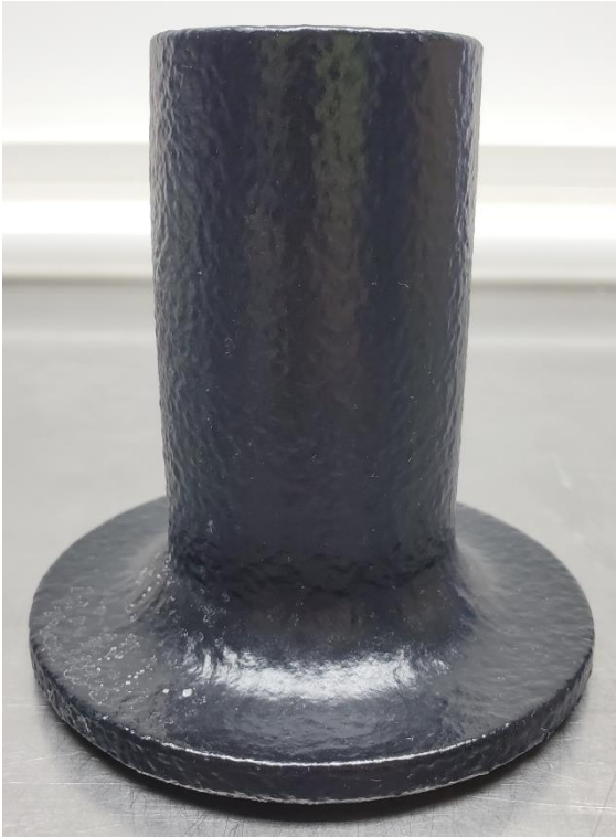
Abbildung 258: 4_Allgemeines Muster_FFF_Zylinder in PA6 (0,4mm) mit Upol RAPTOR, schwarz_nach Test_#1
