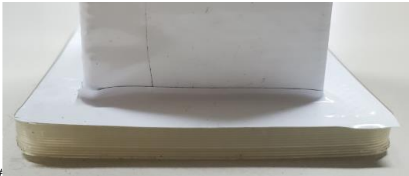
Abbildung 74: 3_Allgemeines Muster_FFF_Quader in PA6 (0,4mm) mit Hexis CARPRO300 (300µm)_#3
