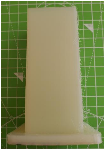
Abbildung 69: 3_Allgemeines Muster_FFF_Quader in PA6 (0,4mm) _#1
