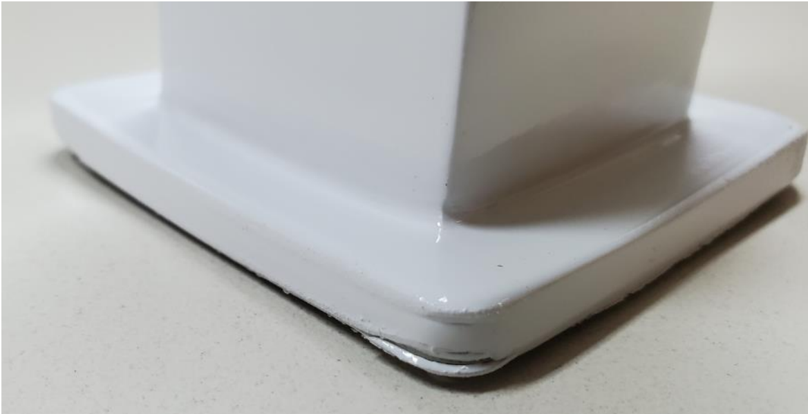
Abbildung 108: 3_Allgemeines Muster_FFF_Quader in PA6 (0,6mm) mit LECHSYS LS155, weiß_#3
