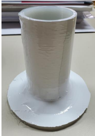
Abbildung 151: 4_Allgemeines Muster_FFF_Zylinder in PA6 (0,4mm) mit Hexis CARPRO300 (300µm)
