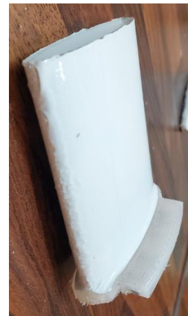
Abbildung 154: 5_Allgemeines Muster_FFF_Ellipse in PP (0,4mm) mit Hexis CARPRO300 (300µm)_zuge-schnitten
