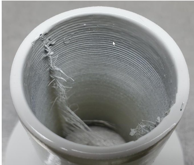
Abbildung 265: 4_Allgemeines Muster_FFF_Zylinder in PA6 (0,6mm) mit LECHSYS LS155, weiß_nach Test_#4
