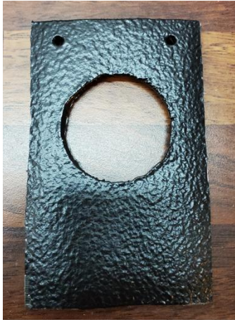
Abbildung 163: 2_Allgemeines Muster_UD-Tape_2 in MCP1223 PA6 CF mit Raptor_vor Bewitterungstest_#1
