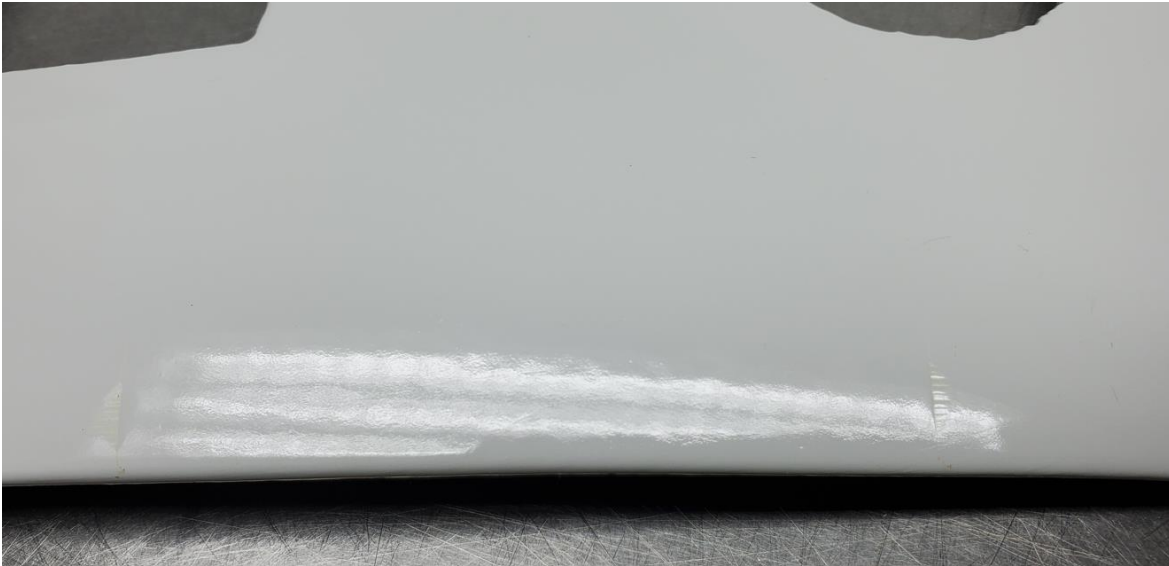
Abbildung 239: 2_Allgemeines Muster_UD-Tape_2 in PP Flax mit LECHSYS LS155, weiß_nach Test_#3
