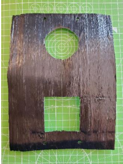
Abbildung 27: 2_Allgemeines Muster_UD-Tape_2 in MCP1223 PA6 CF_#1
