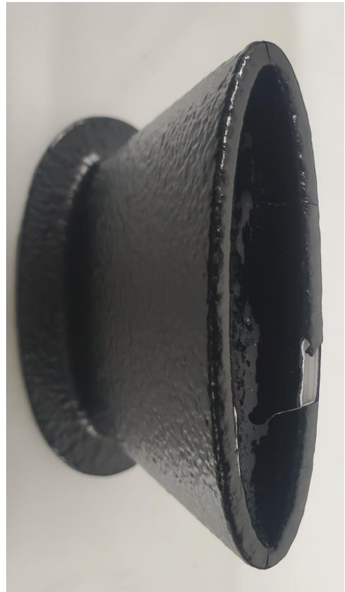
Abbildung 213: 5_Allgemeines Muster_FFF_Ellipse in PP (0,4mm) mit Upol Raptor, schwarz_#2
