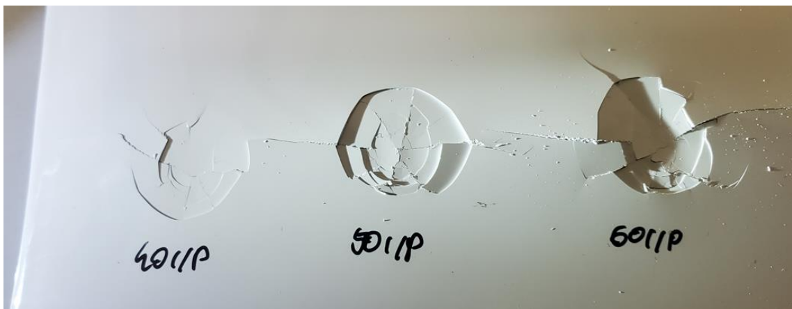
Abbildung 195: 1_Allgemeines Muster_UD-Tape_1 in PA6 Carbon mit LECHSYS LS155, weiß_Vorderseite_#2
