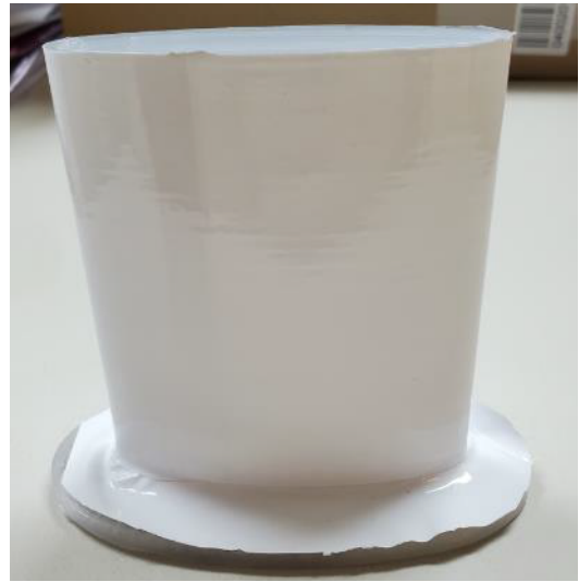
Abbildung 88: 5_Allgemeines Muster_FFF_Ellipse in PP (0,4mm)_mit Wrap Folie Serie 2080 (110µm)_#1
