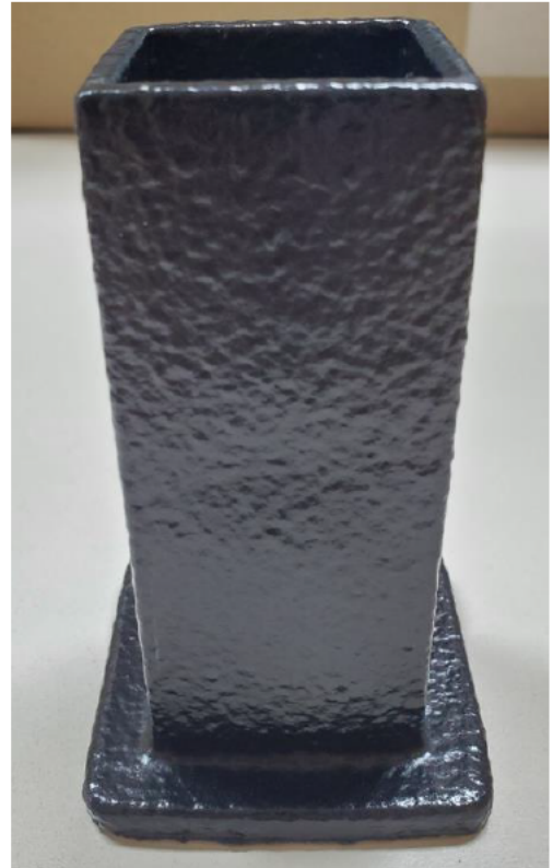
Abbildung 110: 3_Allgemeines Muster_FFF_Quader in PP (0,6mm) mit Raptor, schwarz_#1
