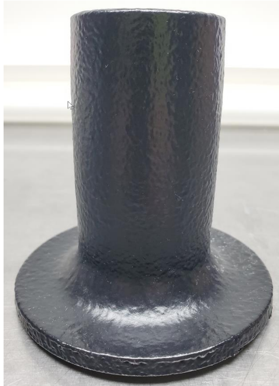
Abbildung 259: 4_Allgemeines Muster_FFF_Zylinder in PA6 (0,4mm) mit Upol RAPTOR, schwarz_nach Test_#2
