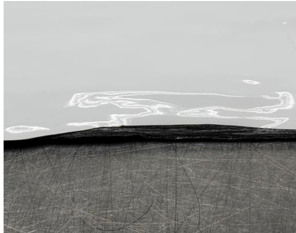
Abbildung 243: 2. Allgemeines Muster_UD-Tape_2 in PA6 Carbon mit 3M Wrap Folie Serie 2080 (110µm)_nach Test_#4
