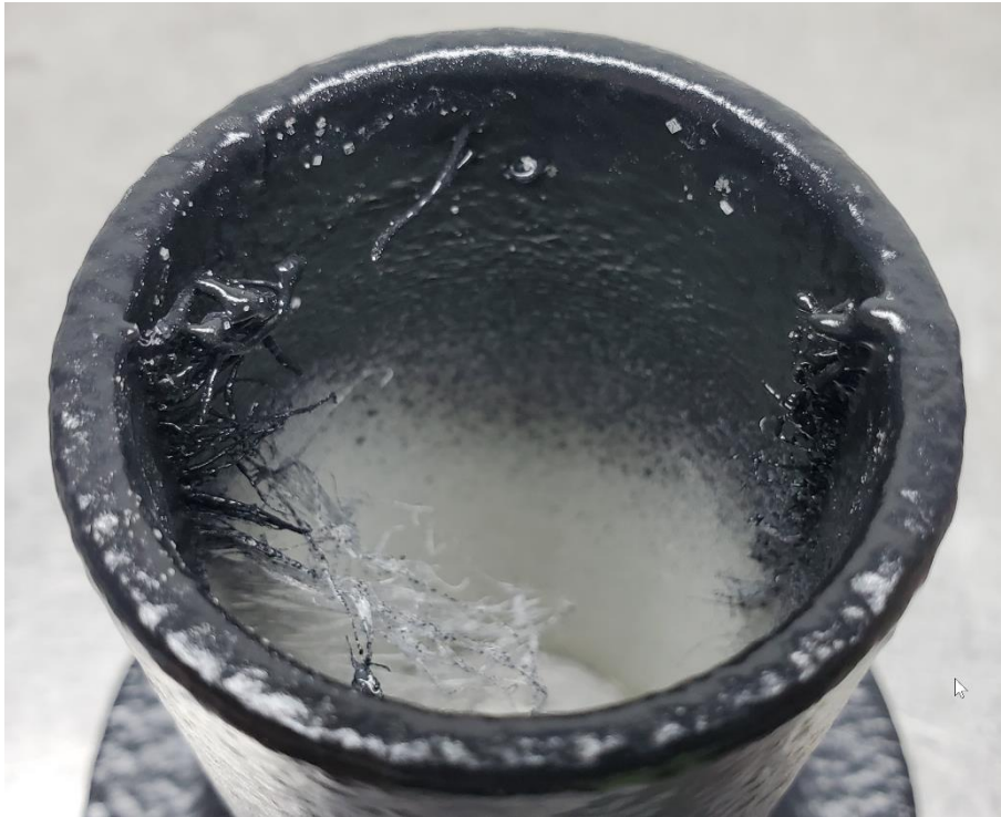
Abbildung 261: 4_Allgemeines Muster_FFF_Zylinder in PA6 (0,4mm) mit Upol RAPTOR, schwarz_nach Test_#4
