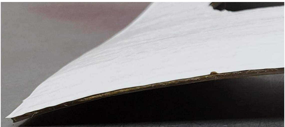
Abbildung 234: 2_Allgemeines Muster_UD-Tape_2 in PP Flax mit 3M Wrap Folie Serie 2080 (110µm)_nach Test_#2
