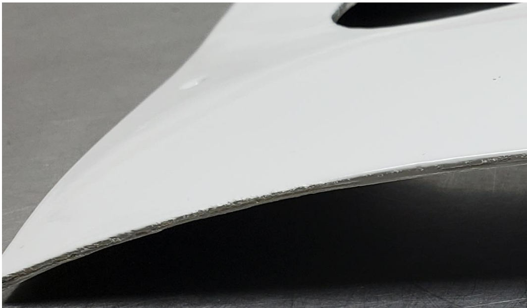
Abbildung 238: 2_Allgemeines Muster_UD-Tape_2 in PP Flax mit LECHSYS LS155, weiß_nach Test #2
