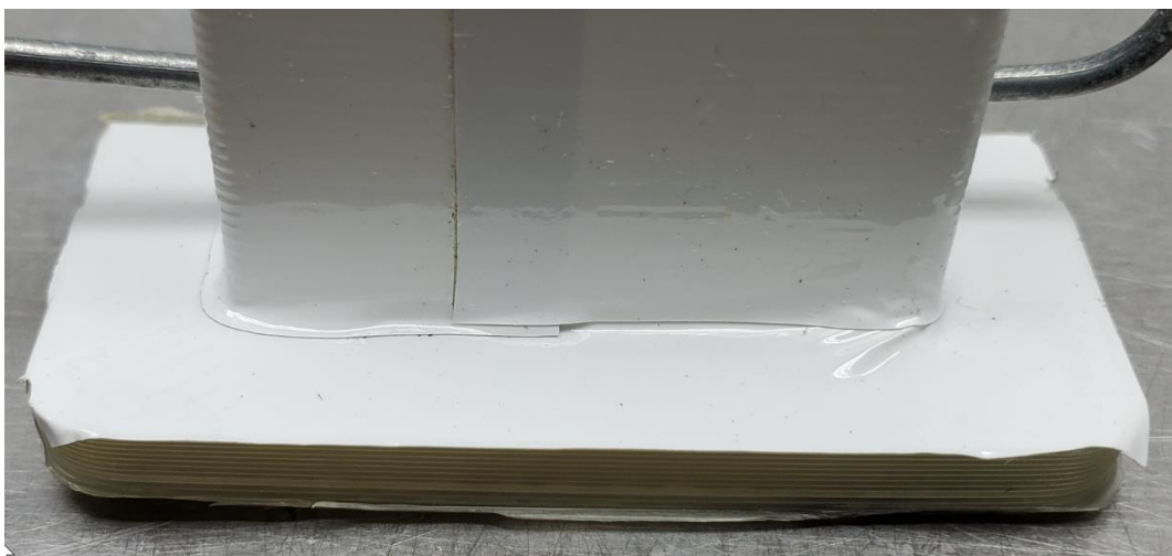
Abbildung 172: 3_Allgemeines Muster_FFF_Quader in PA (0,4mm) mit Wrap Folie Serie 2080 (110µm)_nach Bewitterung_#2
