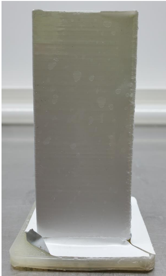
Abbildung 253: 3_Allgemeines Muster_FFF_Quader in PA6 (0,4mm) mit Hexis (300µm)_nach Test_#1
