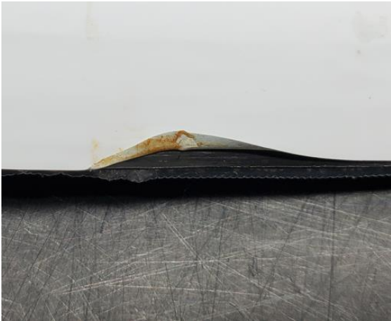
Abbildung 242: 2. Allgemeines Muster_UD-Tape_2 in PA6 Carbon mit 3M Wrap Folie Serie 2080 (110µm)_nach Test_#3
