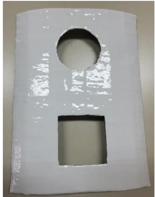
Abbildung 64: 2_Allgemeines Muster_UD-Tape_2 in PP Flax 50 mit Wrap Folie Serie 2080 (110µm) und Hexis CARPRO300 (300µm)_#1
