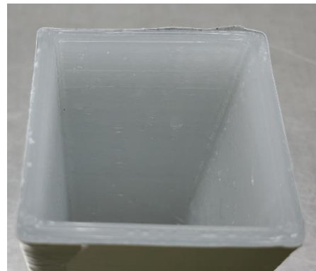
Abbildung 252: 3_Allgemeines Muster_FFF_Quader in PP (0,4mm) mit 3M Wrap Folie Serie 2080 (110µm)_nach Test_#4
