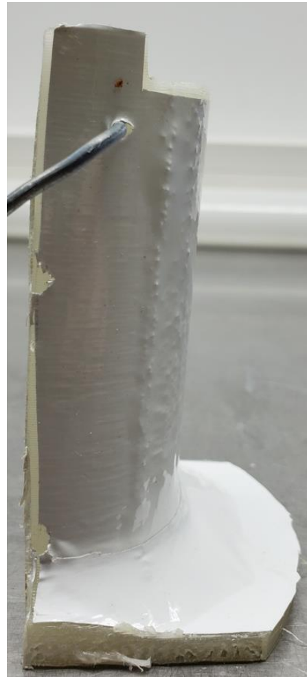
Abbildung 178: 4_Allgemeines Muster_FFF_Zylinder in PA6 (0,4mm) mit Hexis CARPRO300 (300µm)_nach Bewitterung_#4
