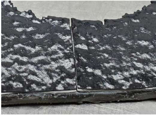
Abbildung 168: 2_Allgemeines Muster_UD-Tape_2 in MCP1223 PA6 CF mit Raptor_nach Bewitterungstest #5
