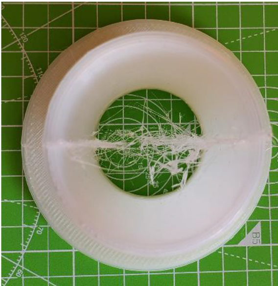
Abbildung 41: 4_Allgemeines Muster_FFF_Zylinder in PA6 (0,4mm)_#2
