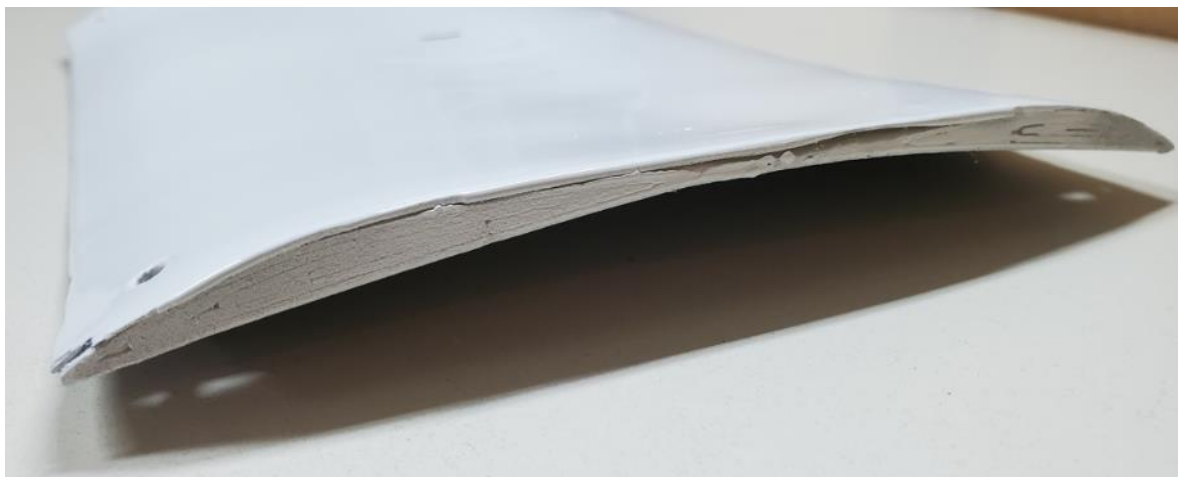
Abbildung 95: 1_Allgemeines Muster_UD-Tape_1 in MCP1223 PA6 CF mit LECHSYS LS155, weiß_#2
