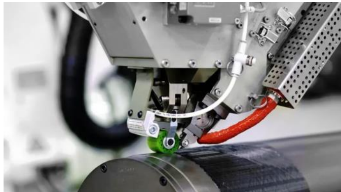
Abbildung 3: Schichtaufbau mittels automatisierten UD-Tape legen 3
