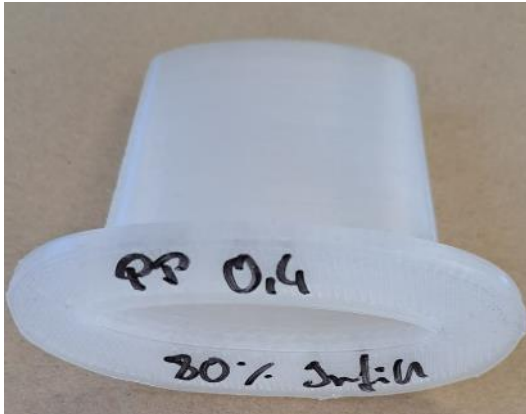
Abbildung 121: 5_Allgemeines Muster_FFF_Ellipse in PP (0,4 mm)
