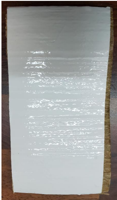
Abbildung 157: 1_Allgemeines Muster_UD-Tape_1 in PP Flax 50 mit Wrap Folie Serie 2080 (110µm)_vor Bewitterung_#1
