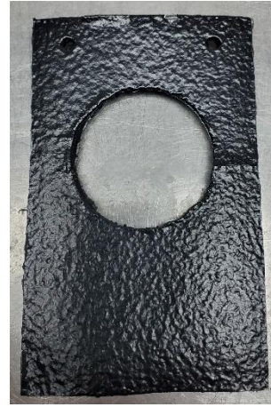
Abbildung 164: 2_Allgemeines Muster_UD-Tape_2 in MCP1223 PA6 CF mit Raptor_nach Bewitterungstest_#1
