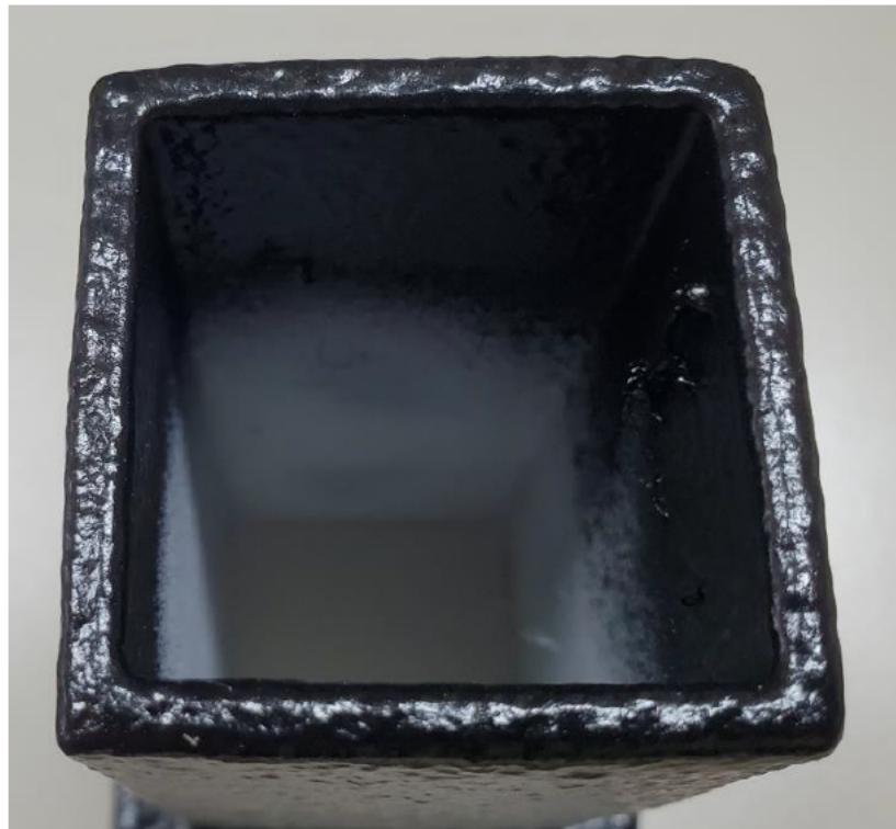
Abbildung 111: 3_Allgemeines Muster_FFF_Quader in PP (0,6mm) mit Raptor, schwarz_#2
