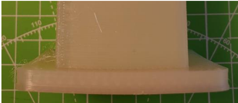
Abbildung 73: 3_Allgemeines Muster_FFF_Quader in PA6 (0,4mm)_#3
