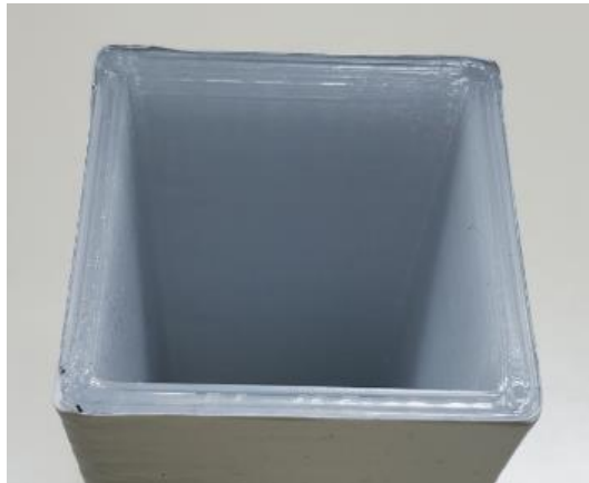
Abbildung 80: 3_Allgemeines Muster_FFF_Quader in PP (0,4mm) mit Wrap Folie Serie 2080 (110µm) und Hexis CARPRO300 (300µm)_#3
