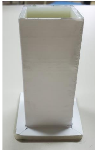
Abbildung 70: 3_Allgemeines Muster_FFF_Quader in PA6 (0,4mm) mit Hexis CARPRO300 (300µm) _#1
