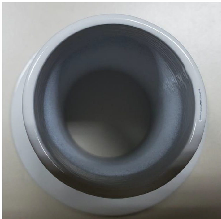
Abbildung 115: 4_Allgemeines Muster_FFF_Zylinder in PP (0,4 mm) mit LECHSYS LS155, weiß_#2
