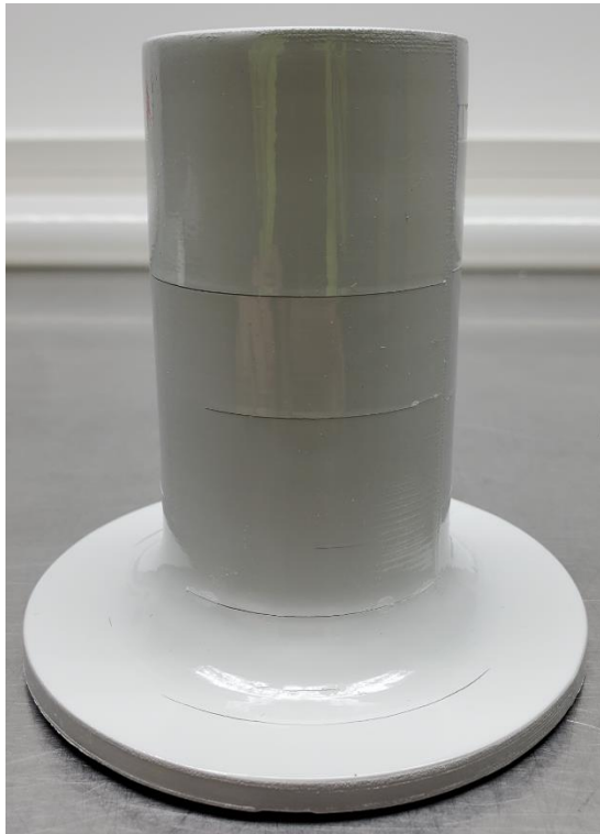
Abbildung 262: 4_Allgemeines Muster_FFF_Zylinder in PA6 (0,6mm) mit LECHSYS LS155, weiß_nach Test_#1
