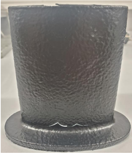
Abbildung 212: 5_Allgemeines Muster_FFF_Ellipse in PP (0,4mm) mit Upol Raptor, schwarz_#1
