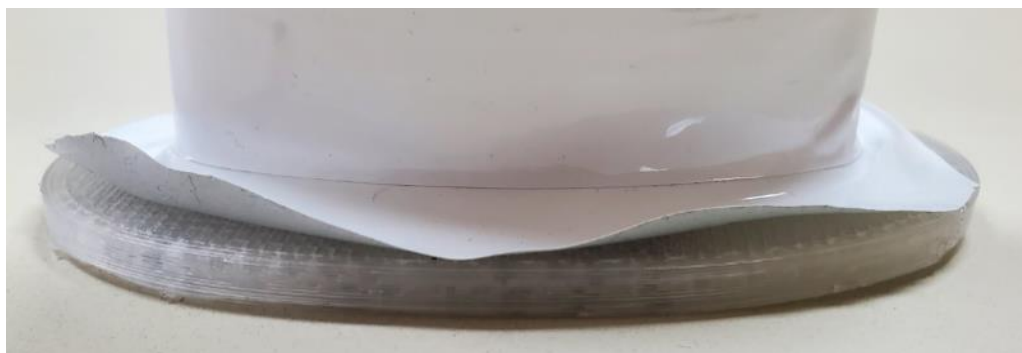
Abbildung 90: 5_Allgemeines Muster_FFF_Ellipse in PP (0,4mm)_mit Wrap Folie Serie 2080 (110µm)_#2
