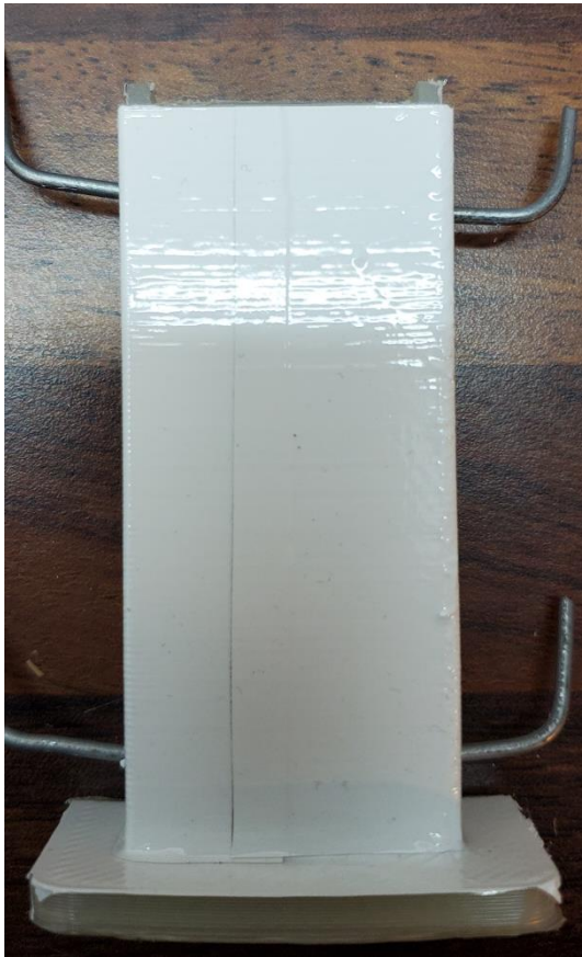
Abbildung 170: 3_Allgemeines Muster_FFF_Quader in PA (0,4mm) mit Wrap Folie Serie 2080 (110µm)_vor Bewitterung_#1
