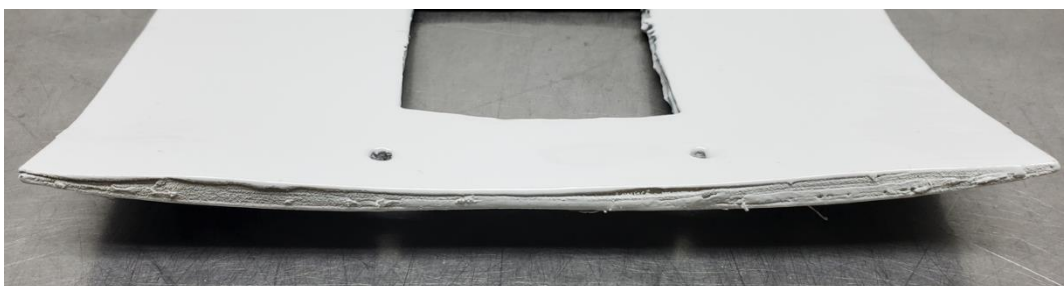
Abbildung 246: 2_Allgemeines Muster_UD-Tape_2 in PA6 Carbon LECHSYS LS155, weiß_nach Test_#3
