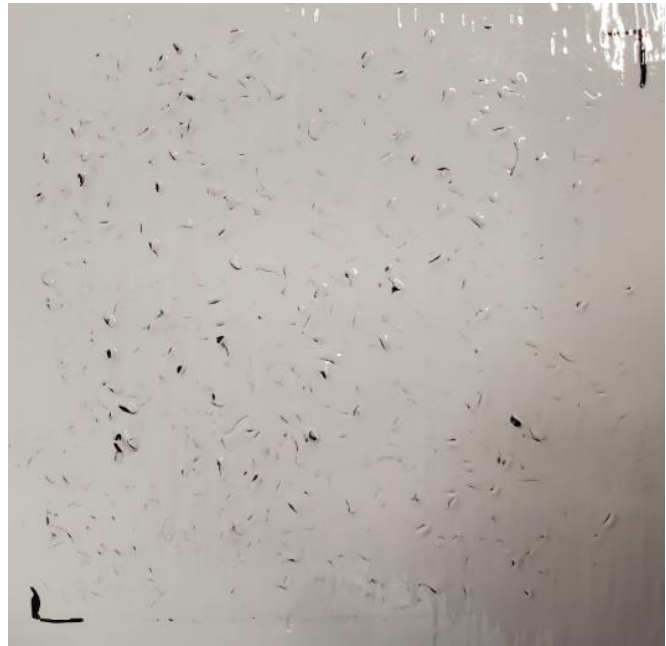
Abbildung 136: 1_Allgemeines Muster_UD-Tape_1 in PA6 Carbon mit 3M Wrap Folie Serie 2080 (110µm)_#2
