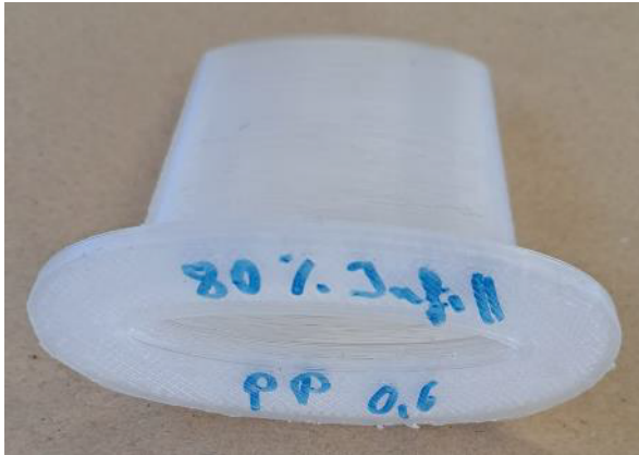
Abbildung 117: 5_Allgemeines Muster_FFF_Ellipse in PA6 (0,6 mm)_#1
