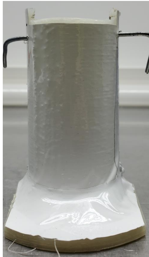
Abbildung 175: 4_Allgemeines Muster_FFF_Zylinder in PA6 (0,4mm) mit Hexis CARPRO300 (300µm)_nach Bewitterung_#1
