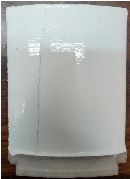
Abbildung 179: 5_Allgemeines Muster_FFF_Ellipse in PP (0,4mm) mit Hexis CARPRO300 (300µm)_vor Bewitterung_#1
