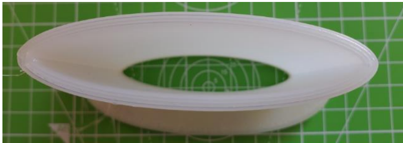
Abbildung 47: 5_Allgemeines Muster_FFF_Ellipse in PA6 (0,6mm)_#2
