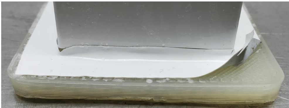
Abbildung 257: 3_Allgemeines Muster_FFF_Quader in PA6 (0,4mm) mit Hexis (300µm)_nach Test_#4
