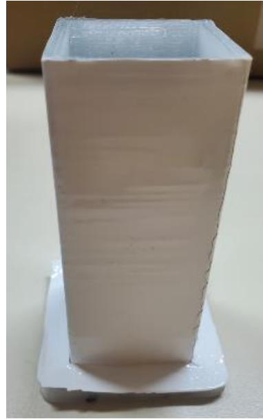
Abbildung 76: 3_Allgemeines Muster_FFF_Quader in PP (0,4mm) mit Wrap Folie Serie 2080 (110µm) und Hexis CARPRO300 (300µm)_#1
