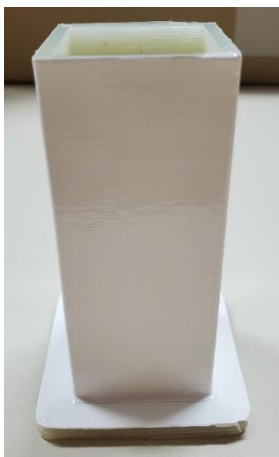
Abbildung 149: 3_Allgemeines Muster_FFF_Quader in PA (0,4mm) mit Wrap Folie Serie 2080 (110µm)
