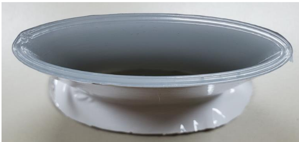
Abbildung 92: 5_Allgemeines Muster_FFF_Ellipse in PP (0,4mm)_mit Wrap Folie Serie 2080 (110µm)_#3
