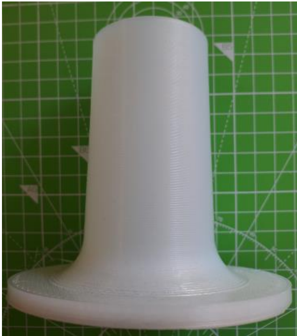
Abbildung 81: 4_Allgemeines Muster_FFF_Zylinder in PA6 (0,4mm)_#1
