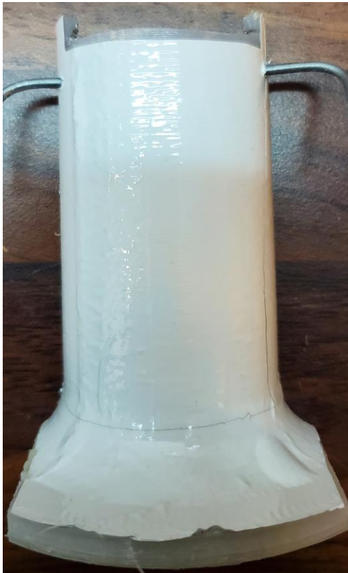
Abbildung 174: 4_Allgemeines Muster_FFF_Zylinder in PA6 (0,4mm) mit Hexis CARPRO300 (300µm)_vor Bewitterung_#1
