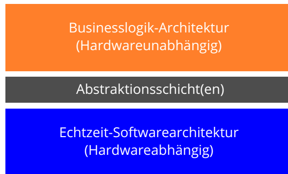
Abbildung 3.4: Eine Softwarearchitektur für eingebettete Systeme besteht aus zwei Architekturen, welche über eine Abstraktionsschicht verbunden werden [19].
