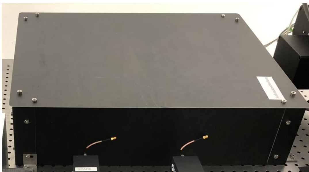
Abbildung 19: Abschirmkasten für den Anregungsstrahlengang
