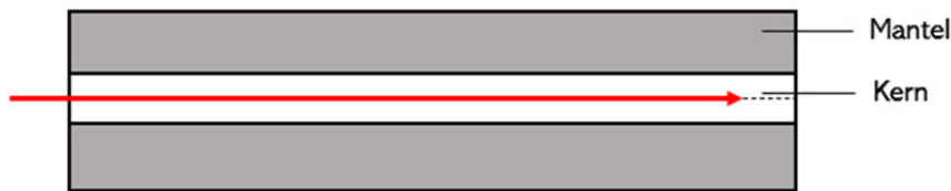
Abbildung 8 : Lichtausbreitung im Glasfaserkabel
