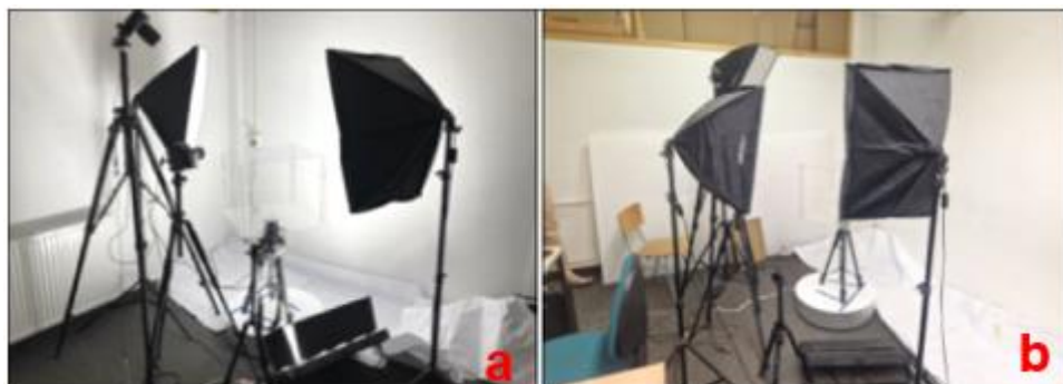
Abbildung 16: Set-Up für die photogrammetrischen Aufnahmen der Tasse, a: vorheriges Set-Up, b: verändertes Set-Up mit einer weiteren Softbox hinter der mittleren Kamera [eigene Darstellung]
