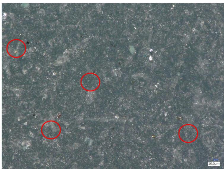
**Abbildung 36. 15 s lang gestrahltes PA 6 unter dem Lichtmikroskop mit 500-facher Vergrößerung**
