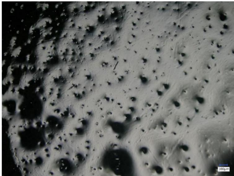
**Abbildung 35. Mit Ameisensäure behandeltes PA 6 unter dem Lichtmikroskop mit 100-facher Vergrößerung**
