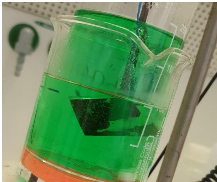
**Abbildung 38. Zuwachsen der Nickelschicht auf der Probe**
