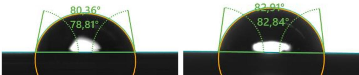
**Abbildung 33. Benetzungswinkel von unbehandeltem PA6 (links) und unbehandeltem PA12 (rechts)**
