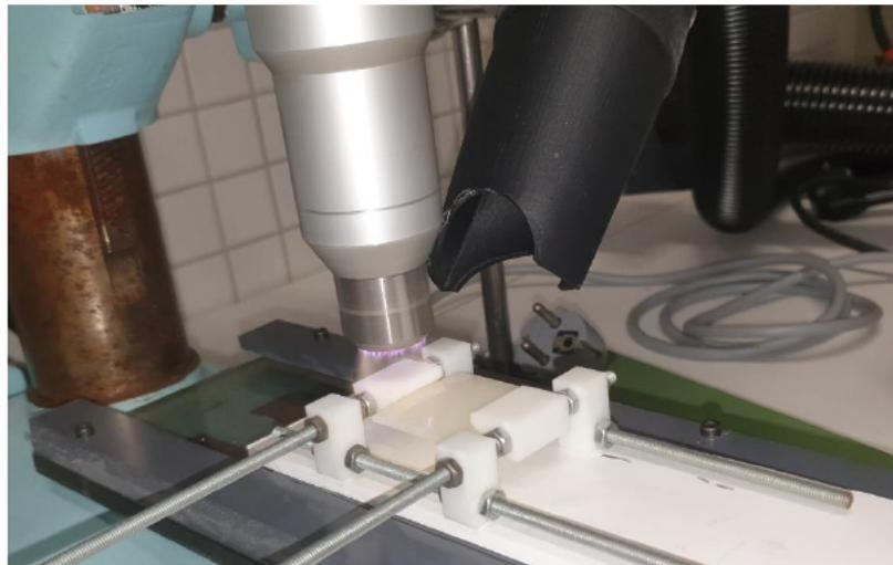
**Abbildung 31. PA 6 - Platte wird mittels Atmosphärendruckplasma vorbehandelt**
