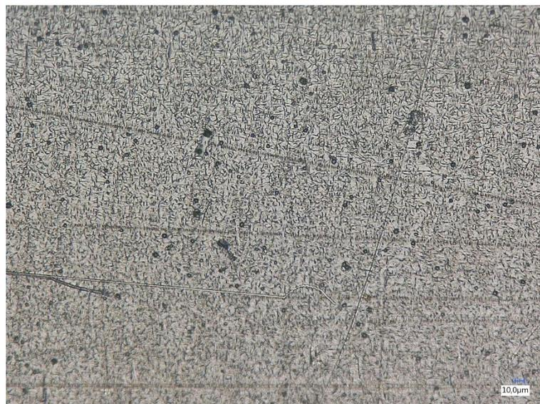
**Abbildung 37. PA 12 nach 20-minütiger Tauchzeit in Kaliumpermanganat unter dem Lichtmikroskop mit 500-facher Vergrößerung**
