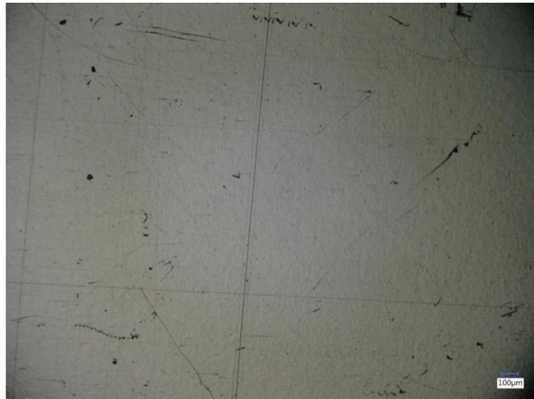
**Abbildung 34. Unbehandeltes PA 6 unter dem Lichtmikroskop mit 100-facher Vergrößerung**
