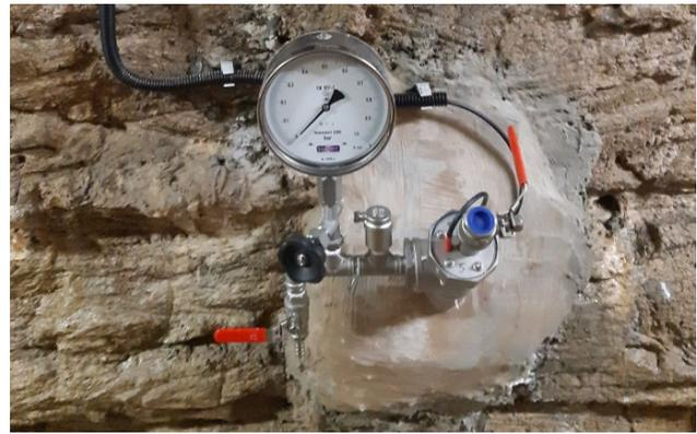
Abb. 12.: Ausbauf orm einer nicht dauerhaft artesischen Messstelle mit Entlüfter
