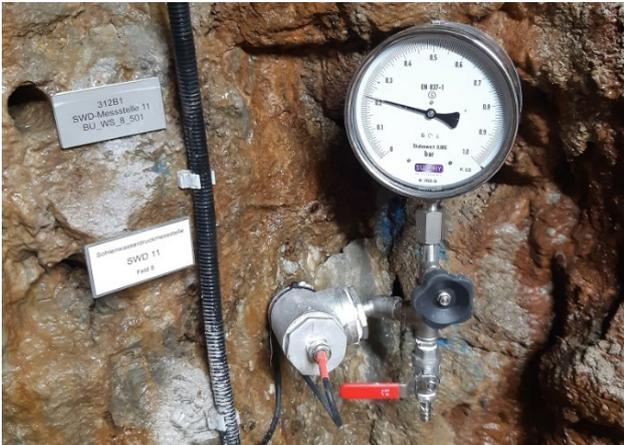
Abb. 10: Ausbauf orm einer artesischen Sohlwasserdruckmessstelle mit Manometer
