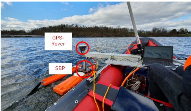
Abbildung 3: Sub-Bottom Profiler (SBP) SES 2000 Kompakt Das Gerät wurde beim Messeinsatz mit einem Trimaran neben dem Messboot hergezogen. Die Positionsbestimmung erfolgte durch Kopplung mit einem Leica GS18 I GPS Rover, welcher über dem SBP positioniert wurde
