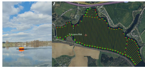
Abbildung 2: USV (SONOBOT) (linkes Bild) des IWWN beim Messeinsatz und beispielhafte Darstellung der Fahrtrouten des USV (rechtes Bild) zur flächigen Aufnahme der Bathymetrie des Stausees der Talsperre Pirk. (Quelle: open sea map/Software Neptus)
