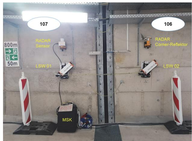
Abb. 3: Tunnel-Monitoring unter Zentraldeponie Leipzig mit LSW- und Radar-Messungen, WEV 2023 [5]
