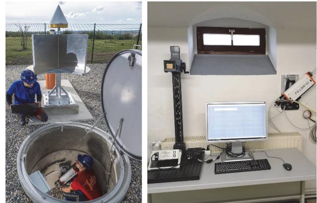
Abb. 6: Multisensor-Geomonitoring-Station mit LSW 02 (links) [6], Steigerhaus, KG-Labor mit LSW 01, PC, Steuerbox (rechts)
