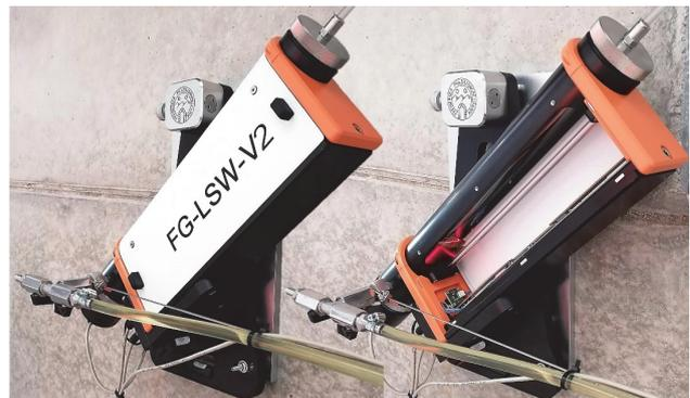
Abb. 1: Hydrostatische Laser-Präzisionsschlauchwaage (LSW) nach Kubisch, Lorenz, WEV 2023 [5]
