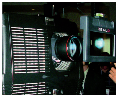
Abbildung 22: Z-Screen vor einem DLP Cinema™-Projektor [112]
