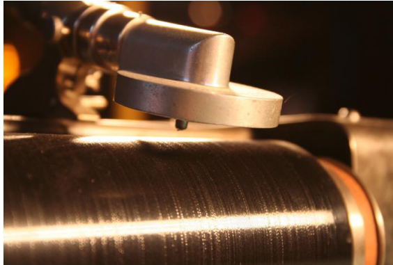
Abb.: 1.1. Walze und Nadel eines Phonographen [Fichtinger 23.06.2009, online]
