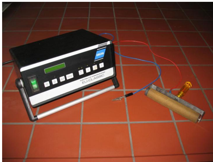
Abbildung 5-4 Geräteausstattung für die chemische Berasterung
