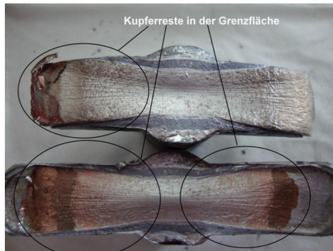
Abbildung 8-3 Kupferverteilung über den Querschnitt in der Grenzschicht
