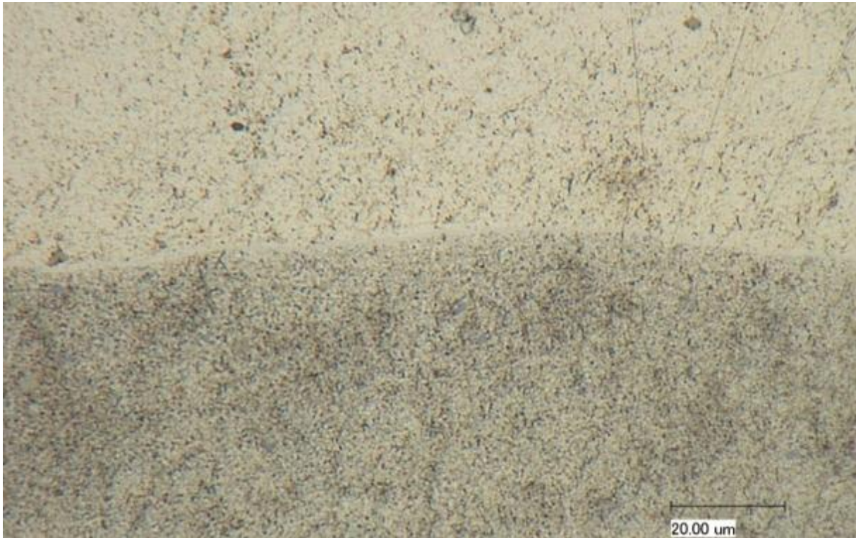
Anhang 1-7 Probe P_7 Al-Zn-Mg Querschnitt im Zylinder bei 2000 facher Vergrößerung
