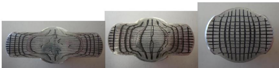
5. Umformschritt ... 3. Umformschritt ... 1. Umformschritt
