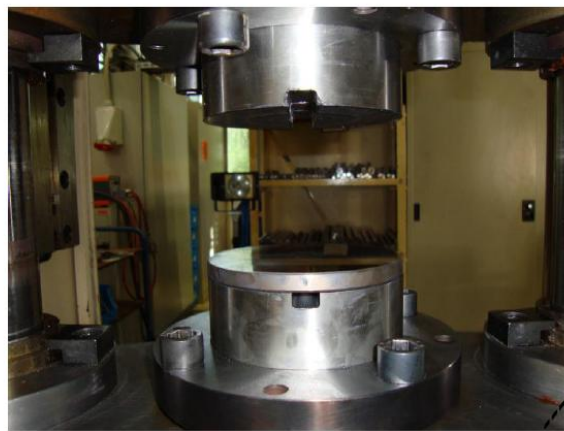
Pressen der Proben mit Zwischenplatte im Querfließpresswerkzeug
