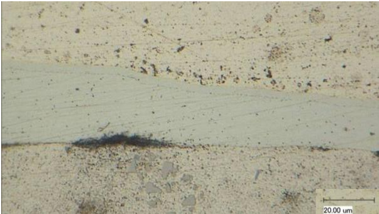
Anhang 1-9 Probe P_8 Längsschnitt im Zapfenbereich bei 2000 facher Vergrößerung
