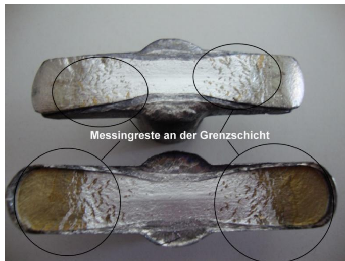
Abbildung 8-3 Kupferverteilung über den Querschnitt in der Grenzschicht
