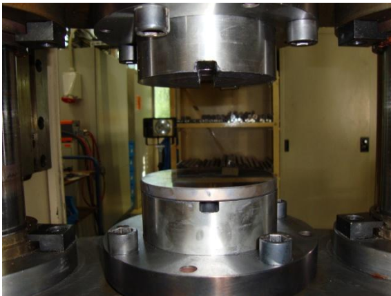
Abbildung 5-15 Werkzeug mit armierten Matrizen und der Zwischenplatte
