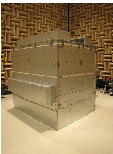
Abbildung 7.2: Variante 2, während der Intensitätsmessung
