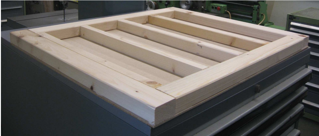
Abbildung 6 : Aufbau der Holzbalkendecke im Modell (ohne Absorptionsmaterial)
