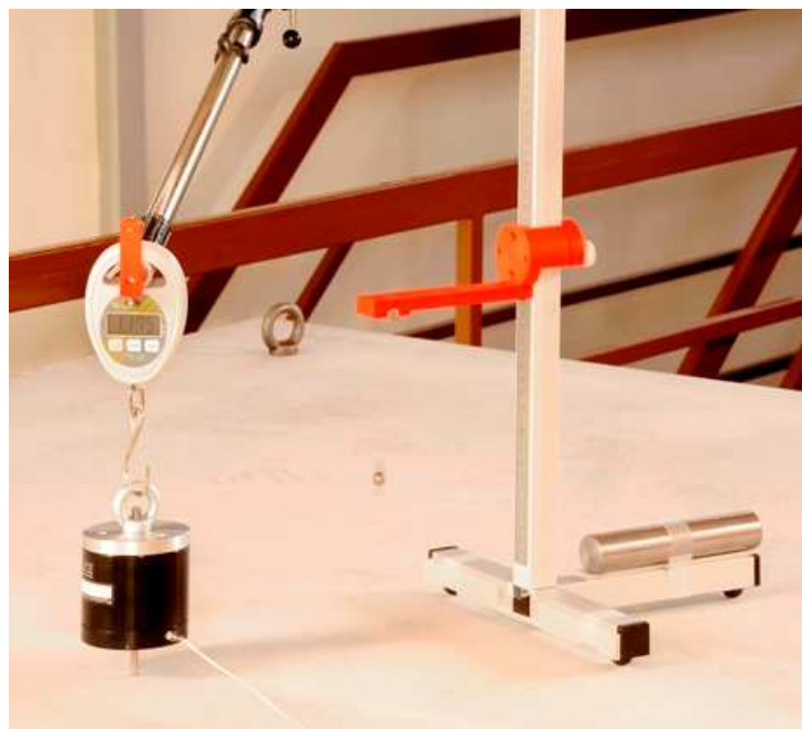
Abbildung 8: Anregungsquellen – links ist der Shaker dargestellt und rechts der Kugelfallapparat
