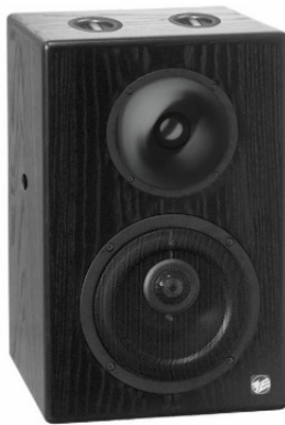
Abb. 34 Das Demonstrationsmodell mit koaxialem und Hornhochtöner (Computersimulation)
