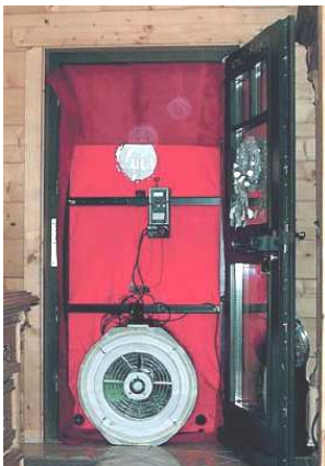
Abbildung 3: Blower-Door-Gebläse im Türrahmen 64
