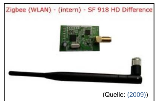
Abbildung 26: Zigbee WLAN Modul
