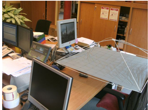
FKM Erdmagnetfeldmessung, der aufgespannte Messraster in Brusthöhe am Arbeitsplatz
