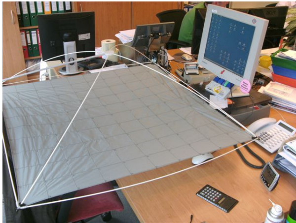
FKM Erdmagnetfeldmessung, der aufgespannte Messraster in Brusthöhe am Arbeitsplatz
