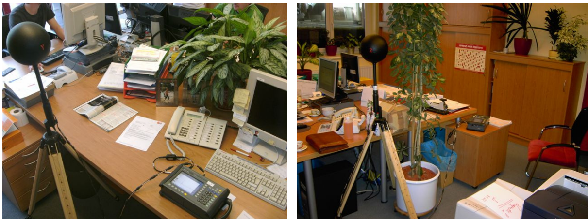
Abb. 2-10: Bilder Messung HF Feld, isotrope Antenne, Messkabel und Spektrum Analyzer
