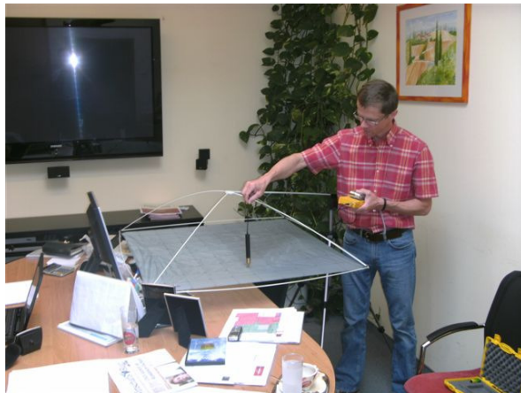
Abb. 2-13: Bild der FKM Messung und das Präzisionsteslameter
